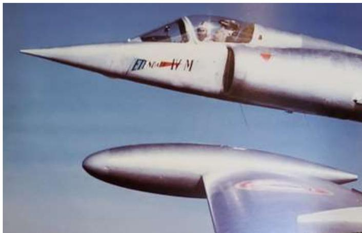
Comparaison des nez de l'Etendard IV M-01 aux mains de JMS, pas encore équipé de la quille de série, en comparaison de celui de l'Etendard IV M-03 des pages 73, 74 et 75 (l'Etendard IV M-01 est vu ici dans la baie de La Ciotat le 11 mars 1959, en patrouille avec un Zéphyr aux mains de l'EV Ruytinx). Le photographe qui a subi un combat, ne se sentait pas très bien...
