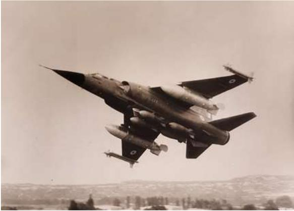
JMS aux commandes du Mirage F1-03 agressif en passage à la Tour à Istres, le 19 mai 1971 (vol domaine 550 kt / Mach 0,9 avec deux réservoirs de 1200 litres sous voilure, quatre bombes de 400 kg au point central et deux Magic 550).
