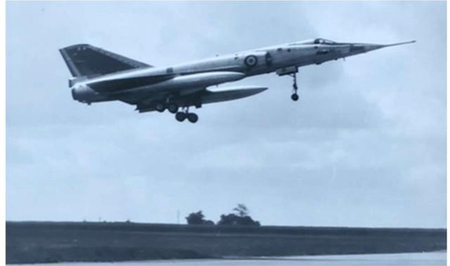
Mirage IV A43 avec deux réservoirs de 4000 litres
