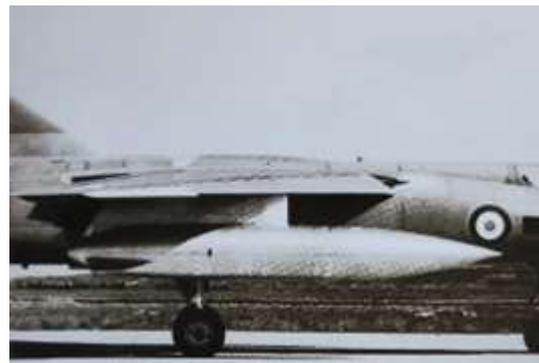
*Jean Coureau effectua sur le Mirage F2-01 des essais d'emport de bidons de 2000 litres avec différents types de pylônes (à bord d'attaque droit et incliné) ; un exemplaire de ces bidons est visible au Musée Européen de l'Aviation de Chasse de Montélimar.*
