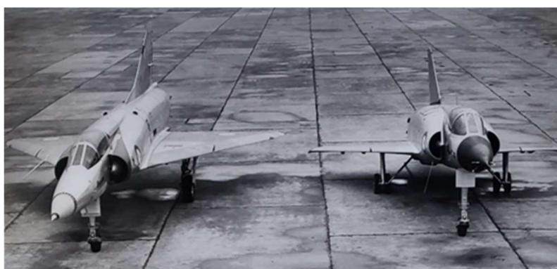
Comparatif des formes générales du démonstrateur Balzac V. 001 avec le train encore fixe, à celles d'un Mirage III A
