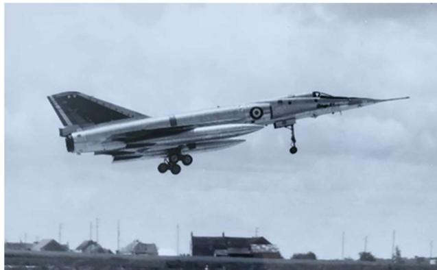
Mirage IV A43 avec deux réservoirs de 3000 litres
