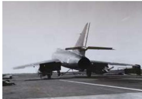
Ici, JMS aux commandes de l'Etendard IV M-02 au catapultage à Thurleigh, le 27 septembre 1962 avec un 1300 litres et un " conteneur " de Mirage IV à 11,5 tonnes avec un centrage de 24,7%... avec une composante de vent arrière sur la catapulte (→ une bonne accélération longitudinale de 5,5 g +)
