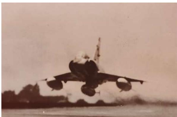
Mirage 5 BA-01 aux mains de JMS, au décollage Melun-Villaroche le 7 octobre 1970 (essai radio-altimètre en configuration deux réservoirs de 1700 litres sous voilure et un 1300 litres au point central)
