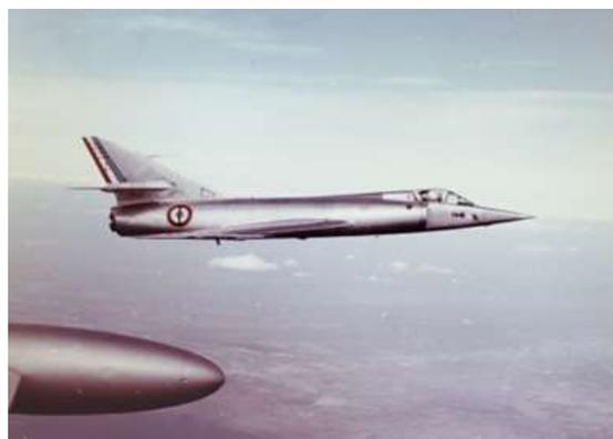
L'inscription temporaire est différente sur le côté droit de l'Etendard IV M-01 et les bouts de plan du -01 ne sont pas repliables au contraire de ceux des Etendard suivants
