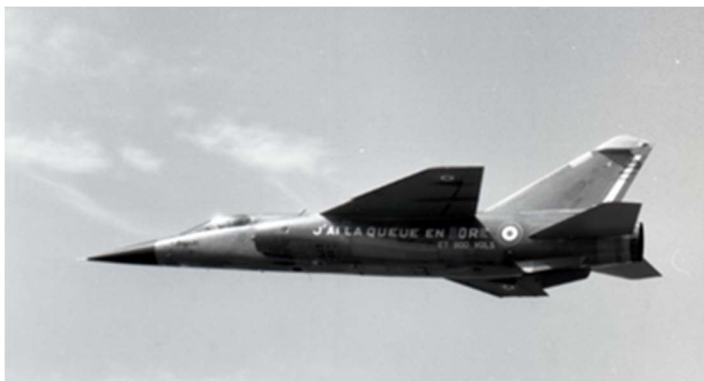
JMS aux commandes du Mirage F1-02 atteint Mach 2,15 et 750 kt lors d'un essai de domaine avec le nouvel empennage horizontal en bore à Istres, le 18 mai 1976.
