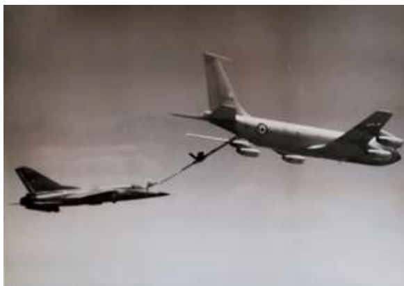
Le 28 mai 1974, JMS Saget procéda à des essais de ravitaillement sur le Boeing C-135 F. 38470, aux commandes du Mirage G8-02 à 25 000, 30 000 et 34 000 ft
