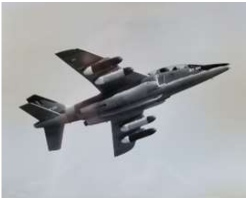
Vol d'emport pour l'AlphaJet AT-01 aux mains de JMS, équipé de 4 LAU3 B/A à Istres, le 18 octobre 1979
