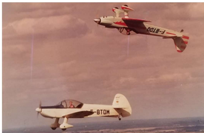
Le Cap 10 B F-BTDM (premier Cap 10 civil) de l'aéro-club Dassault Voltige aux mains de Claude, tandis que JMS s'entraîne aux premières mises dos en patrouille sur le Cap 20 F-BTDO loué, qui est équipé du système Christen de graissage dos en vol inversé et au miroir à Argenton-sur-Creuse, le 6 août 1974...
