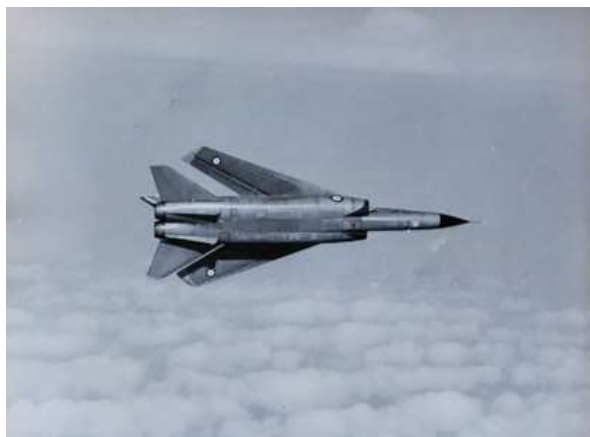
JMS aux commandes du Mirage G8-01, ailes repliées. A 40 000 ft, taux de montée du Mirage G8 = 35 000 ft/min et en palier, plus l'avion va vite, plus il accélère...
