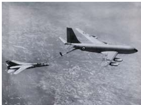
Le 28 mai 1974, JMS Saget procéda à des essais de ravitaillement sur le Boeing C-135 F. 38470, aux commandes du Mirage G8-02 à 25 000, 30 000 et 34 000 ft
