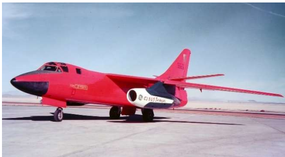
Moteur General Electric CJ805-02 en essais sous l'aile du banc volant Douglas B-66 " Destroyer ". Photo crédit service communication de GE.
