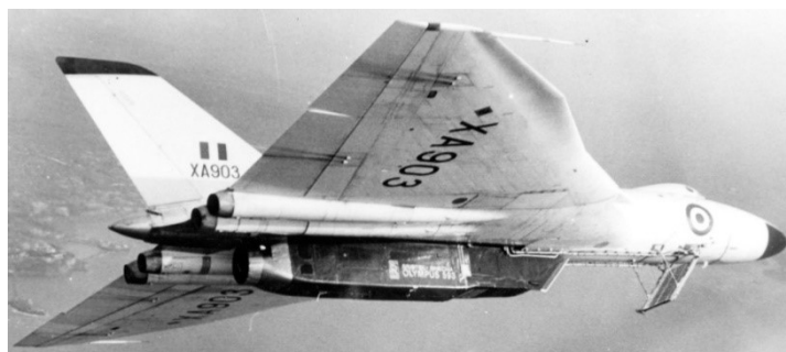
AVRO 698 " Vulcan " emportant la nacelle d'essais en vols du moteur Rolls Royce SNECMA Olympus 593 (© DR)
