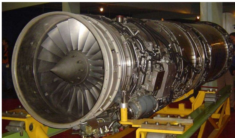
Cône d'entrée et vue du premier étage de compresseur du M53-5 (© DR)
