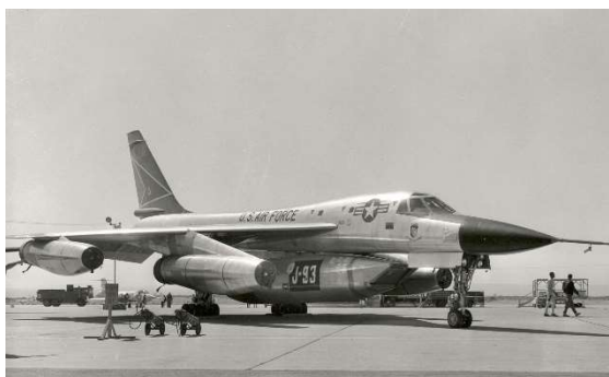
Moteur General Electric J93 dans une nacelle sous fuselage du quadrimoteur Convair NB-58 banc d'essais volant supersonique. Photo crédit service communication de General Electric.
