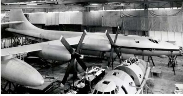
Maquette de construction échelle 1 en bois du Boeing XB-52 représentative de ce qu'aurait pu être le B-52 motorisé par des turbopropulseurs T57.
