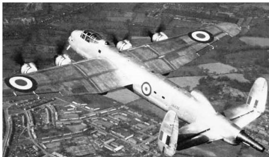
AVRO Lancaster banc d'essais volant du moteur MetroVic F2. Le moteur F2 a pris la place du mitrailleur arrière. On observera que cette version du bombardier Lancaster est motorisée par quatre moteurs Bristol "Hercules". (© MoD)
