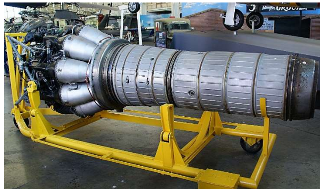
Klimov VK-1. Copie Soviétique du RR " Nene ", le type VK-1A fut produit en grande série en URSS et en Chine sous la désignation WP-5. Il motorisa notamment le Mig-15. (© DR)
