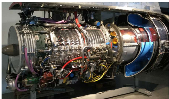
General Electric CJ805. Vue en coupe d'un CJ805 pour Convair 990. Une partie du conduit d'amenée de l'air secondaire destiné à la soufflante arrivant de l'avant de la nacelle est disposée autour du carter de la turbine haute pression.
