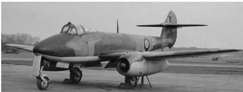
Prototype F9/40M du Gloster "Meteor" F1 propulsé par deux moteurs MetroVic F2. On observe les nacelles sous voilure à la "Messerschmitt 262". (© MoD)
