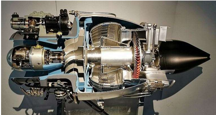
" Ecorché " du turboréacteur Turboméca Marboré II (© Turboméca)
