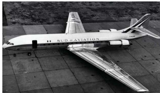
Rare vue de l'unique Sud Aviation " Caravelle " acquise par General Electric pour tenter de promouvoir le moteur CJ805. Au-delà de cet unique avion, le projet n'eut pas de suite. Photo crédit service communication de GE.
