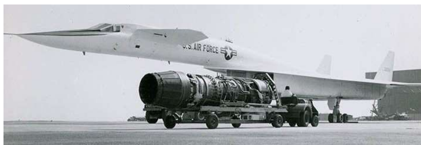
North American XB-70 " Walkyrie ". Sur la base d'Edwards, pendant la période des essais en vols, moteur General Electric J93 devant l'un des deux prototypes du XB-70. Photo crédit internet.
