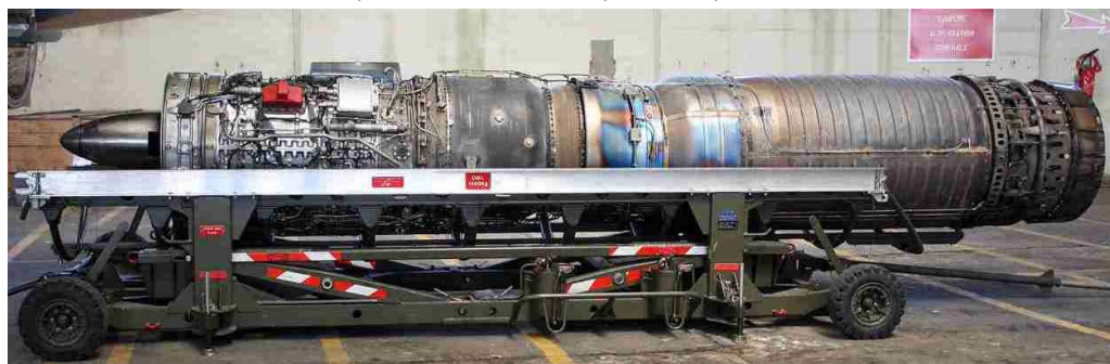
ATAR 9K50 sur son chariot de "dépose-pose" " (© DR)
