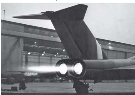
De Havilland " Gyron Junior " au plein gaz postcombustion installés, à fin d'essais, dans un unique exemplaire du Gloster " Javelin " FAW Mk.1. (© DR)
