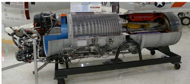
Coupe d'un moteur Allison J71. Les accessoires sont installés d'une façon peu usuelle au centre de l'entrée d'air imposant deux manchons d'admission courbés. Photo crédit internet.
