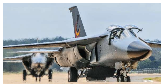
Entrée d'air de dernière génération de l'avion General Dynamics F-111. Moteur P&W TF30. Photo crédit internet.
