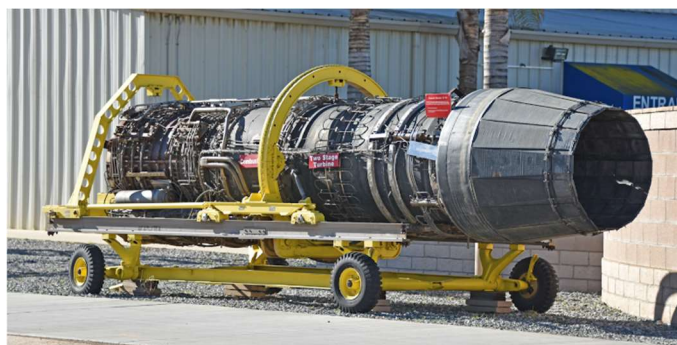
Moteur General Electric J93 du XB-70 sur son dispositif de transport. Photo crédit internet.
