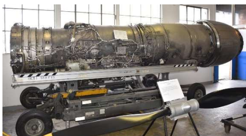
Moteur Pratt & Whitney TF30-P-414A version Grumman F-14 sur bâti de dépose. Copyright : Oakland Aviation Museum.
