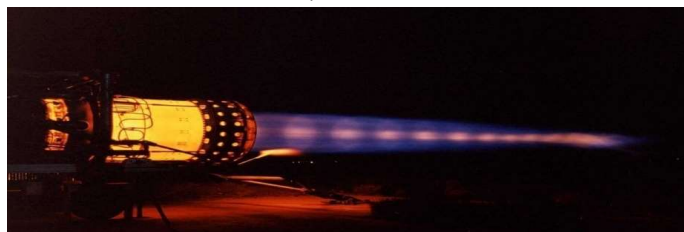
Impressionnant dard de la post combustion d'un moteur P&W J58 installé sur un Lockheed SR-71. Photo crédit internet.
