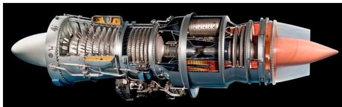
Coupe d'un moteur P&W JT3-C, la taille de guêpe est bien visible. Photo crédit National & Space Museum Washington DC.
