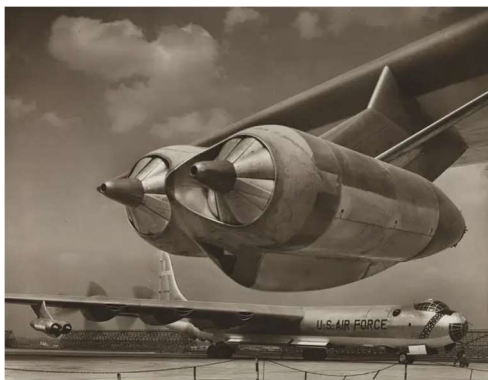
Nacelle double de deux moteurs General Electric J47 sous l'aile d'un bombardier Convair B-36 " Peacemaker ". Photo crédit internet.
