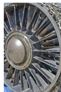
Grille d'entrée d'air du Moteur P&W J58, on observe qu'une partie du bord de fuite est à angle de calage variable.
