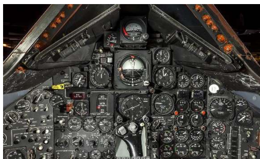
Planche de bord pilote du SR-71. Les instruments relatifs à la conduite des moteurs sont disposés sur la droite du panneau central. Photo crédit internet.
