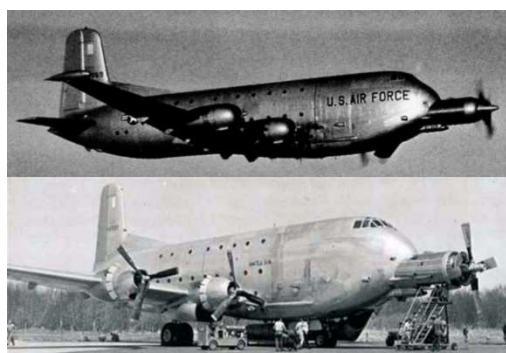
Turbopropulseur P&W XT57-P-1 installé dans le nez d'un quadrimoteur Douglas JC-124 Globemaster II. Photo crédit internet.
