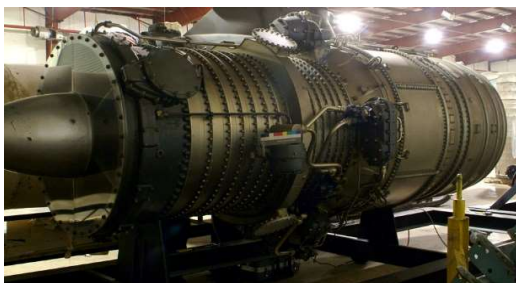
Première version, désignée T- 8 " Barrel case " du J57, rapidement abandonnée pour difficultés techniques qu'il ne fut pas possible de résoudre (© Pratt & Whitney)
