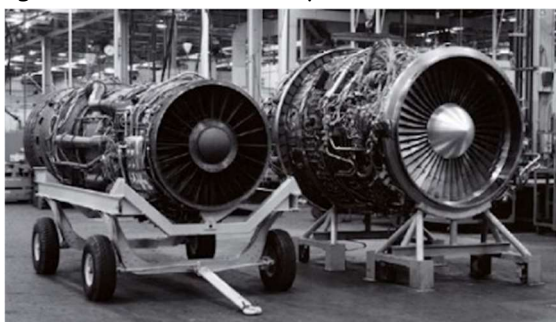
Moteur J58 à côté d'un prototype du JTF17 concurrent malheureux à la propulsion du Boeing 2707 SST (© P&W)
