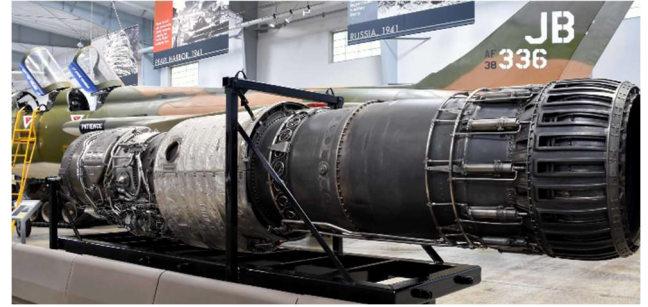
Moteur P&W J75 version avec PC et injection d'eau destinée au Republic F-105 "Thunderchief". Photo crédit Flying Heritage & Combat Armor Museum
