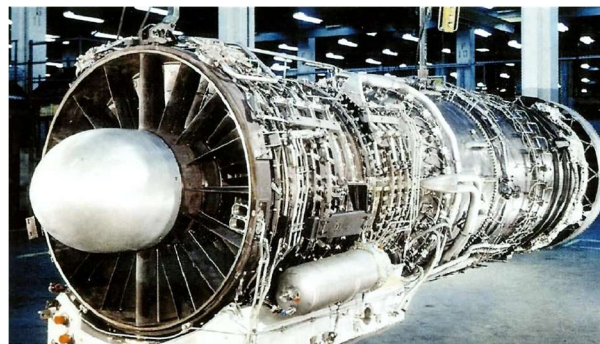
General Electric J93 : vue frontale on aperçoit, à l'avant sous le compresseur le coffre étanche en acier contenant les accessoires. Photo crédit internet.
