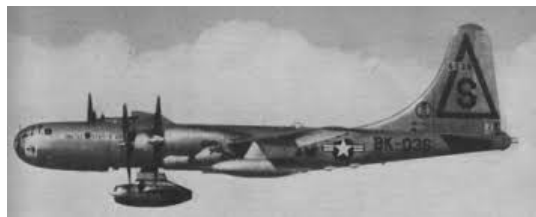
Vue d'un moteur P&W J57 d'essais en nacelle sous un bombardier Boeing B-50. (2)
