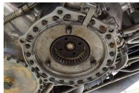
Prise de force destinée à l'arbre d'entraînement du démarreur du moteur P&W J58. Photo crédit internet.
