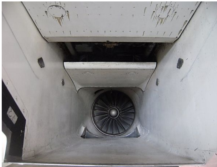
Entrée d'air à géométrie variable.
