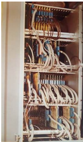
Baie électronique Système SMAC d'ELECMA : cartes numériques d'acquisition de mesures à microprocesseur (1985)
