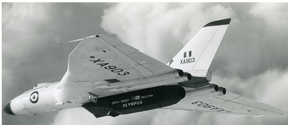
Avro 698 Vulcan Mk1 serial XA903 avec moteur Olympus 593-3B et ensemble d'éjection type 10. La jambe du train d'atterrissage avant, plus longue, provient d'un Vulcan Mk2 parce que la jambe du Mk1 est plus courte, ce qui évite ainsi que la tuyère de l'Olympus 593B ne racle la piste.
