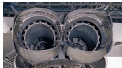
Tuyère secondaire convergente-divergente
