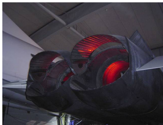
Ensemble d'éjection type 14 - 28 avec une tuyère primaire comportant 36 volets (18 commandés + 18 asservis)
