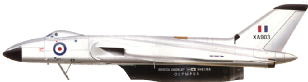
Avro 698 Vulcan Mk1 (B1) serial XA903 avec dispositif de givrage (Mars 1971)
