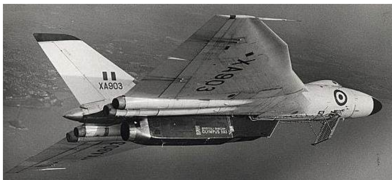
Avro 698 " Vulcan " B Mk1 serial XA903 lors des essais de pulvérisation d'eau (1971) avec une grille de vaporisation installée sous le fuselage avant pour les essais de dégivrage du moteur et de l'entrée d'air.
