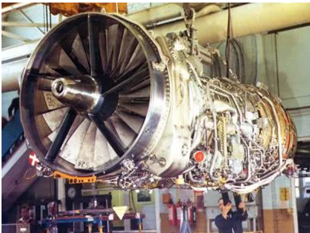
Olympus 593 Mk-610. En vol de croisière supersonique, le moteur se dilatait de près d'un demi-pouce (1,27 cm) en diamètre et d'un pouce (2,54 cm) en longueur.
