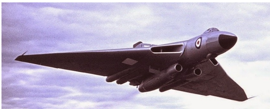
Avro " Vulcan " B1 serial XA894 banc d'essais volant de l'Olympus Mk 320
