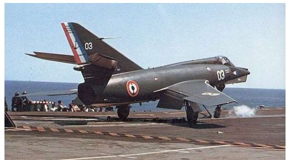
Etendard IV M-03. Les trains principaux encaissent des vitesses d'impact vertical de 6 m/s. Le train avant permet de cabrer l'avion à 10° pour les opérations de catapultages.
