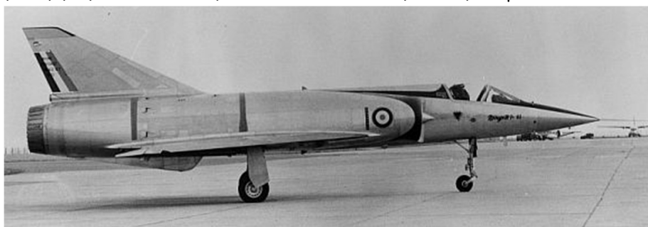
Dassault Mirage III T-01 banc volant des réacteurs TF-104 et TF-106 (© Espace Patrimoine Safran)
