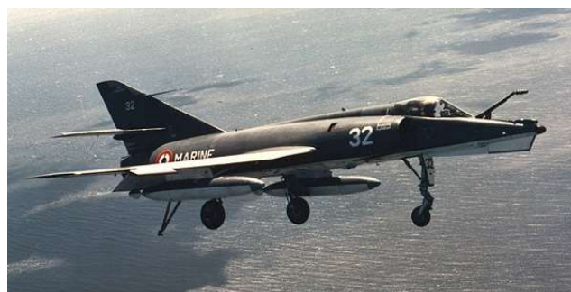
Appontage : Train sorti, Becs, Volets, Compensateurs sortis, Crosse sortie, Aérofreins sortis, Trim -5° (© Marine nationale)
