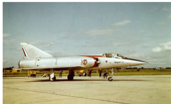
Mirage III T 01 propulsé par un TF-106 au roulage à Melun-Villaroche. La chambre réacteur est ventilée par des écopés. (© Espace Patrimoine Safran).
