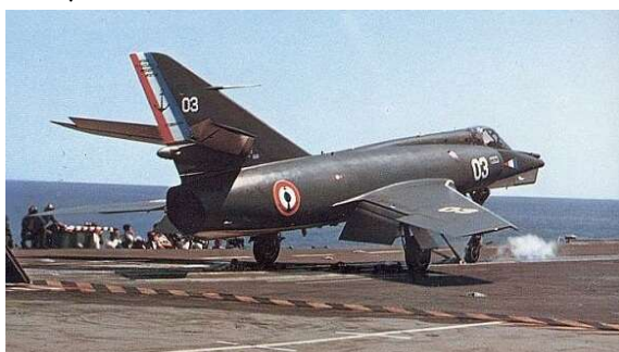
Catapultage : Becs, Volets, Compensateurs sortis, Trim - 6°, Sur gonflage train avant (© Marine nationale)
