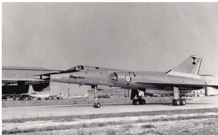
Mirage IV A-04 Essais Atar 9K Istres (Février 1966). L'appareil est décoré de marques (jaune et noir) de haute visibilité, de part et d'autre de la dérive, destinées au ciblage de caméras pour les prises de vues. (© AEVS)
