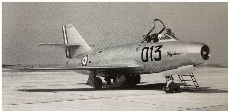
Dassault MD-452 Mystère II 013 avec une verrière basculante " clam-shell " (1955) (© CEV)
