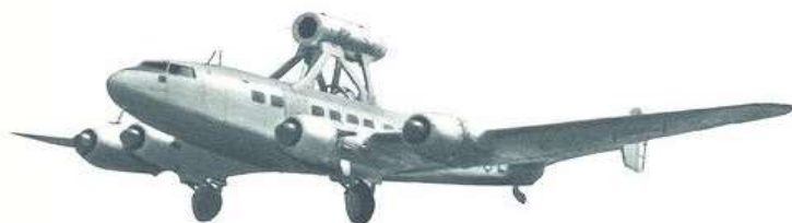
SE-161 " Languedoc " banc d'essais des réacteurs Atar 101 et de l'Atar 8 (Coll. J. Mesnard). Le " Languedoc " n° 83 sera le premier banc volant équipé d'un Atar à postcombustion, le 101 F2, en 1955.
