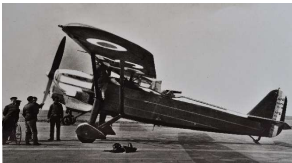
ANF Les Mureaux 113 R2. Identifiable à son aile "PZL" qui gêne la visibilité vers l'avant. Il possédait une maniabilité au-dessus de la moyenne.
