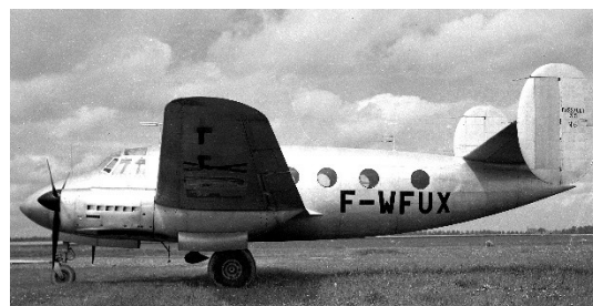
MD-315 " Flamant " n° 6 F-WFUX propulsé par une paire de Renault 12 S avec son immatriculation provisoire F-WFUX (© DR).
