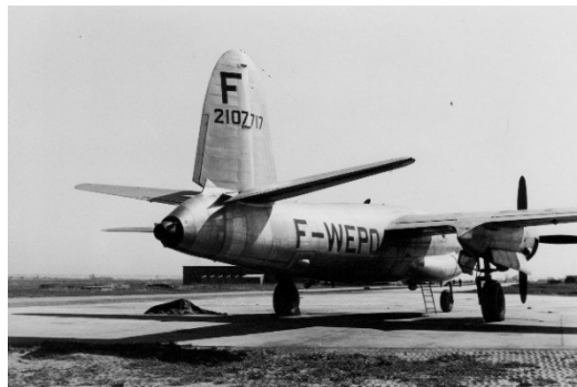
Martin B-26 C-45 "Marauder" serial 42-107717 (F-WEPO) équipé d'un Jumo 004 B (© Collection Ph Ricco)
