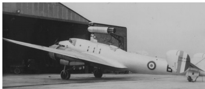
Lioré-et-Olivier LÉO 451 n° 493 E8 (E pour Essais) codé B banc volant des pulsoréacteurs " Tromblon ", entre 1951 et 1952. Le motoriste réalise dix vols (16 h 30) aux mains de quatre pilotes. (© Espace Patrimoine Safran)
