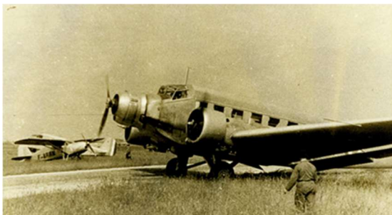
AAC 1 " Toucan " n° 180 avec le moteur 14 NC en position centrale (© Espace Patrimoine Safran)
