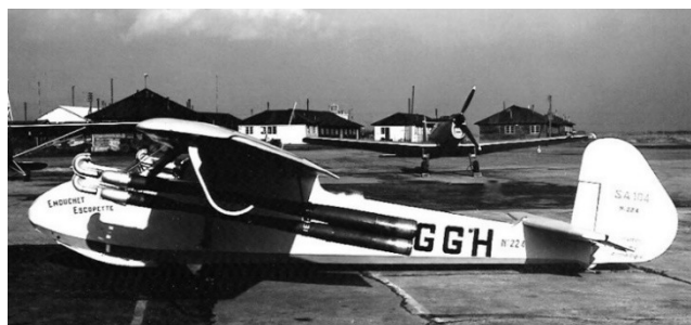
Arsenal SA-104 " Emouchet " n° 224 : un planeur qui décolle tout seul. Notez les entrées d'air des pulsoréacteurs courbées vers l'arrière. (© Espace Patrimoine Safran)
