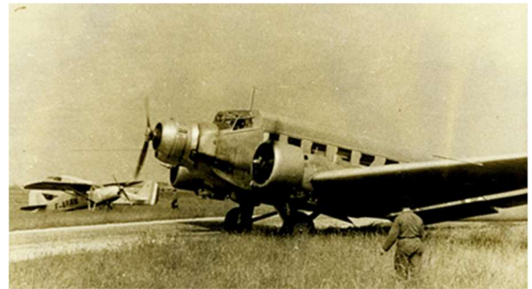
Amiot AAC.1 " Toucan " banc volant moteur à huile lourde 14 NC (© Espace Patrimoine Safran)
