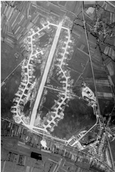
Ambérieu-en-Bugey, code Y-5 (1944). La piste en herbe fait 1 600 x 1 050 mètres. La piste en béton et les zones de dispersion ont été construites par les Américains en 1944.
