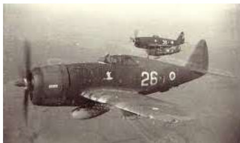
Republic P-47 D 22-RE " Thunderbolt " avec arête dorsale (" razorback ") et verrière coulissante.
