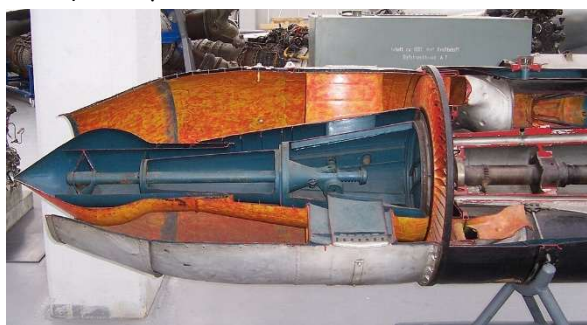
Coupe de la tuyère à striction du moteur Jumo 004. Le déplacement longitudinal du cône est commandé par un système à crémaillère. (© DR)
