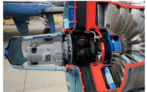
Démarreur de forte puissance en 28 volts du Snecma Atar 8 C (prototype). (© DR)
