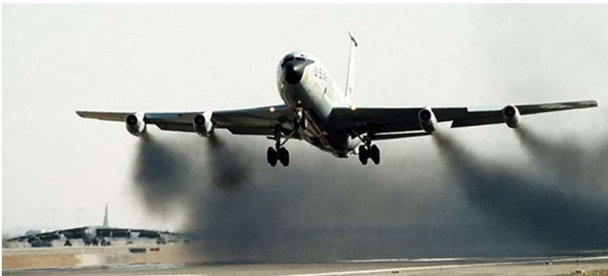
Boeing KC-135 - P&W JT3 C avec injection d'eau au décollage (© US Air Force)
