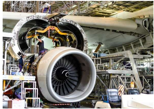
Opération de dépose de l'aile d'un avion, par " Bootstrap ", d'un moteur Rolls-Royce Trent. (Crédit internet)
