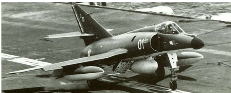
Super Etendard 01 à l'appontage. Les trains principaux encaissent des vitesses d'impact vertical de 6 m/s. Le train avant permet de cabrer l'avion à 10° pour les opérations de catapultages.
