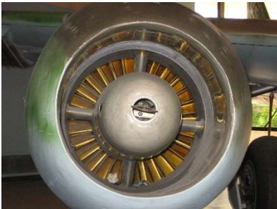
Poigné du lanceur " à ficelle " pour le démarrage en secours du démarreur du Jumo 004. (© DR).
