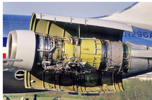
Pratt & Whitney JT8D-200 " Re fan engine " installé en position une sur un McDonnell Douglas de la série MD80.
