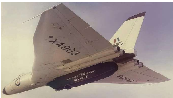
Bombardier quadrimoteur Avro Vulcan utilisé comme banc volant du moteur Olympus 593 destiné à l'avion supersonique Concorde. (© RR)
