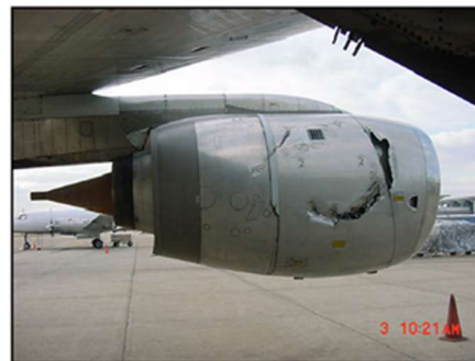
Dégâts associés sur moteur adjacent
