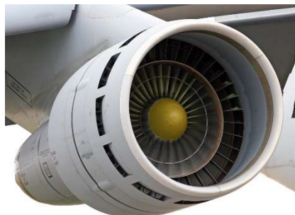
Vue frontale du moteur General Electric TF39. On remarque le demi-étage de soufflante devant la roue conventionnelle et les prises d'air additionnelles périphériques, à l'extérieur de la buse d'entrée d'air du Lockheed C-5A " Galaxy ".
