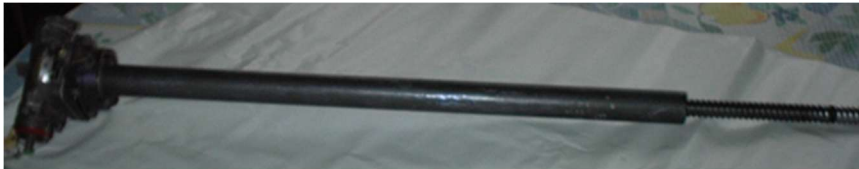
Vérin d'inverseur de poussée du B707/CFM56 (© DR)
