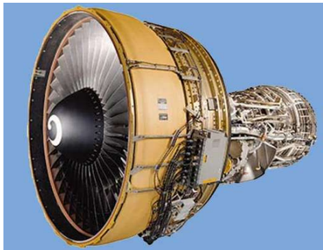
Vue d'un moteur General Electric CF6-80C2/F. On aperçoit le boîtier du calculateur du système FADEC installé, sur le carter de la soufflante, derrière l'anneau en kevlar participant à la rétention, d'éléments qui pourraient être libérés en cas de rupture d'une aube de la soufflante, d'où la désignation /F.
