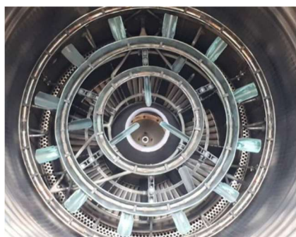
Vue intérieure d'un canal de postcombustion avec les anneaux et les tôles accroche flamme en forme V. A l'intérieur, les anneaux des tuyauteries d'amenée du carburant sous haute pression. (© DR)
