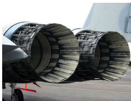
Tuyères à col convergent/divergent de l'avion de combat F-15 "Eagle". La couleur blanchâtre des surfaces indique un dépôt de protection thermique à base de matériaux céramique. (© USAF)
