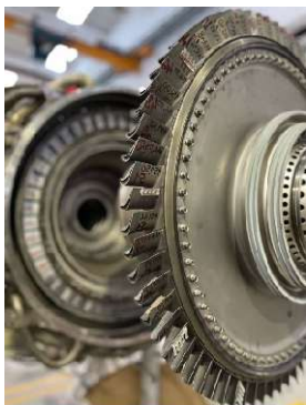
Turbine haute pression d'un CFM56 en cours d'installation. (Crédit internet)
