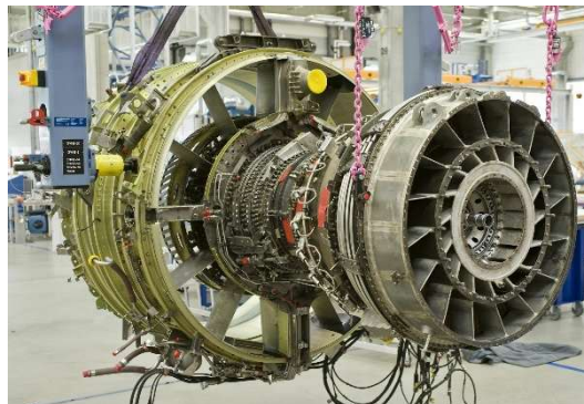
CFM56-7B en fin de visite, en phase de remontage de ses équipements. (Crédit internet)
