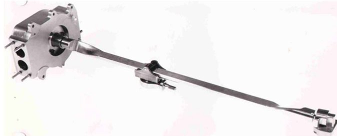
Système de détection de la configuration de l'inverseur de poussée du DC8-70/CFM56 (© DR)
