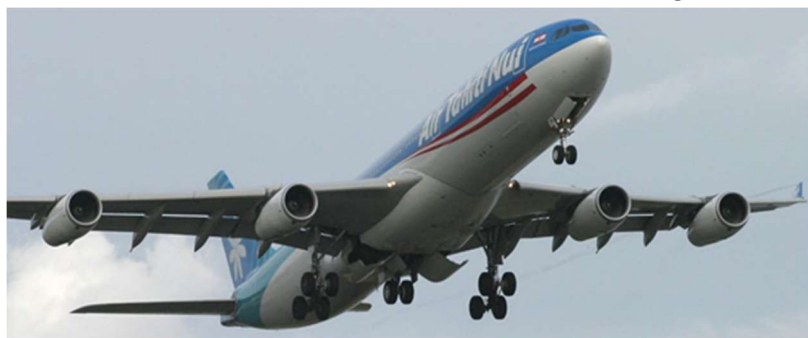
Airbus A340/CFM56-5C- montage en " pod " sous les ailes (© DR)
