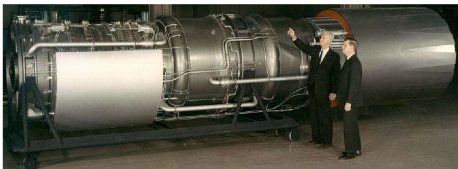
Vue latérale du moteur GE4 destiné à l'avion de transport quadri réacteur supersonique Boeing SST 2707. La présence des deux ingénieurs donne une idée des dimensions de ce moteur. Pour protéger les équipements de la gestion de puissance de l'échauffement cinétique, ils sont installés dans un coffre en acier dans lequel circule du carburant. Ce coffre est bien visible sur le côté du carter du compresseur. (© GE)
