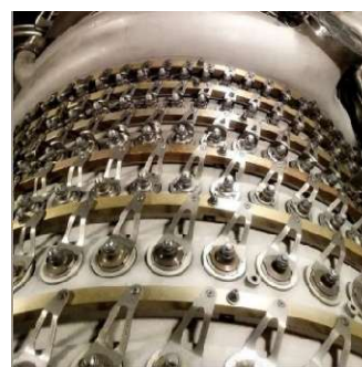
Gros plan des leviers et anneaux de commande du dispositif de commande des stators à calage variable (VSV) du moteur General Electric CF6-80C2. (© DR)
