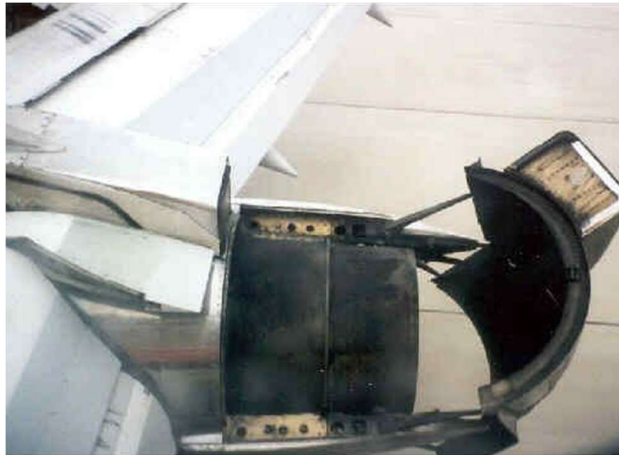
Inverseur de poussée " aval " du Boeing 737-200 (© DR)
