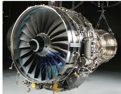
Vue frontale du moteur IAE V2500. On observe les aubes de soufflante à large corde en titane.
