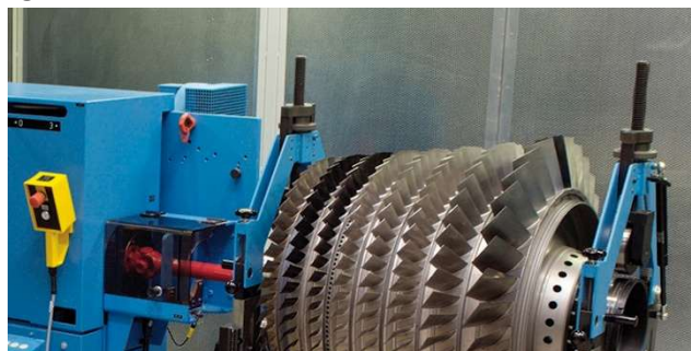
Compresseur haute pression en phase d'équilibrage. (Crédit internet)
