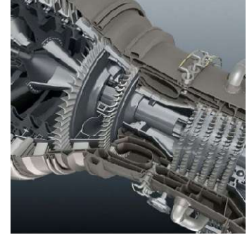
Vue d'artiste d'une architecture triple corps. Au centre, le compresseur et la turbine haute pression, en arrière, la turbine du corps intermédiaire puis l'arbre basse pression avec une vue partielle de sa turbine. (© DR)
