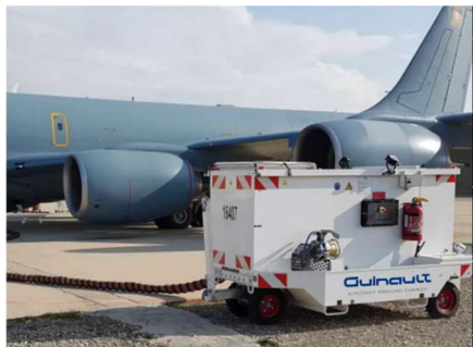
Groupe de parc extérieur Guinault générateur d'air comprimé pour l'assistance au démarrage de démarreurs à air. Le dispositif est connecté à un avion ravitailleur en vol KC-135 FR équipé de moteurs CFM56-2B. (© DR)
