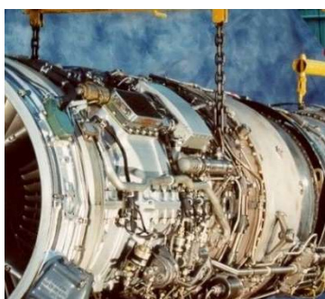
Grille d'échappement de l'air comprimé d'une des deux vannes de décharge du compresseur de l'ATAR 9K50. En haut vers l'avant son vérin de manœuvre à air comprimé. (© Snecma)
