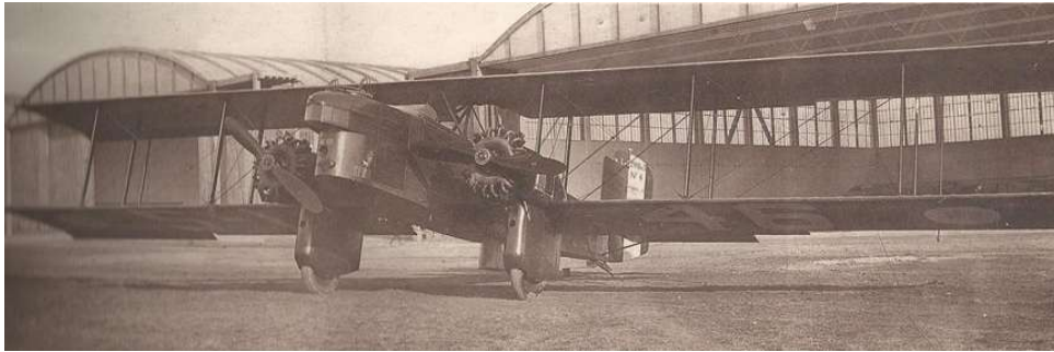
Lioré LeO 20 à Essey-les-Nancy (Collection A. Compo). Construit à 324 exemplaires, ce bombardier emportait une charge égale à son poids à vide : 2 700 kg sur une longue distance, 1 000 km, à une vitesse de 200 km/h.
