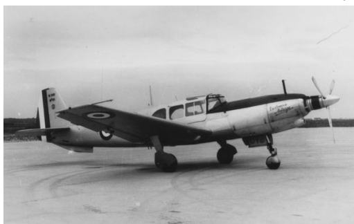
Nord 1100 " Ramier " Astazou (@ DR). Deux exemplaires furent modifiés et équipés d'une turbine Turbomeca " Astazou " II. Le premier essai en vol eut lieu en octobre 1959.
