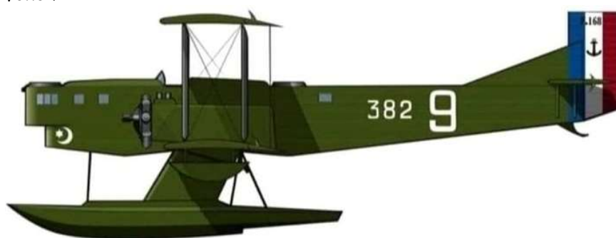
Farman F-168 Goliath à flotteurs (© DR). Hydravion quintuplace de bombardement et de torpillage propulsé par deux Gnome & Rhône 9Akx de 480 ch. Environ 250 bombardiers et avions de ligne de la série F-160 ont été construits, dont 40 bombardiers-torpilleurs d'hydravions F-165 et 200 F-168 pour la marine française.
