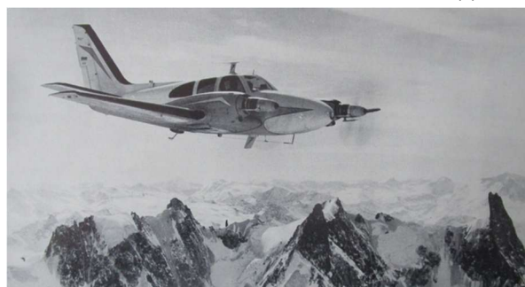
Beechcraft Marquis (@ DR). Avion biturbopropulseur de liaison rapide - 450 km/h. Se pose et décolle en 250 m. Transporte cinq passagers et un pilote.
