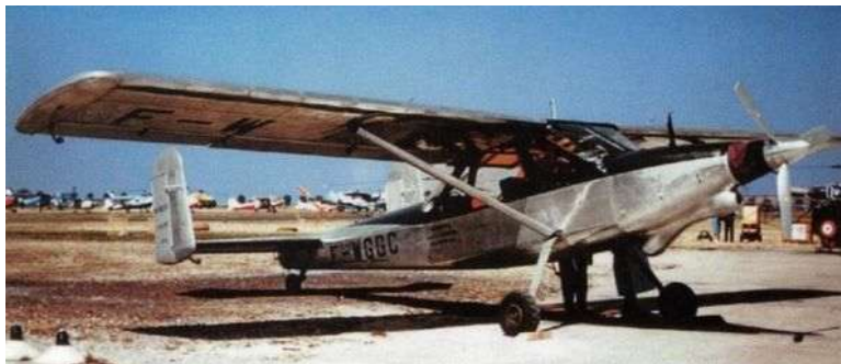
Max Holste MH-153 Boussard équipé d'un turbopropulseur Astazou II d'une puissance de 530 cv (Archives Ch. Faure).
