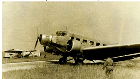
AAC 1 " Toucan " n° 180 banc volant du Gnôme & Rhône 14 NC (© Espace Patrimoine Safran)
