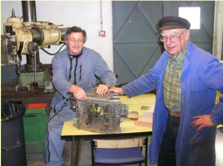
Secteur de carter intermédiaire CFM56 (système de décharge)
