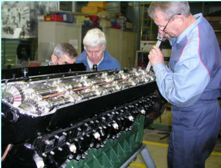
Renault 12 cylindres: le remontage est bien avancé (nov. 2012)
