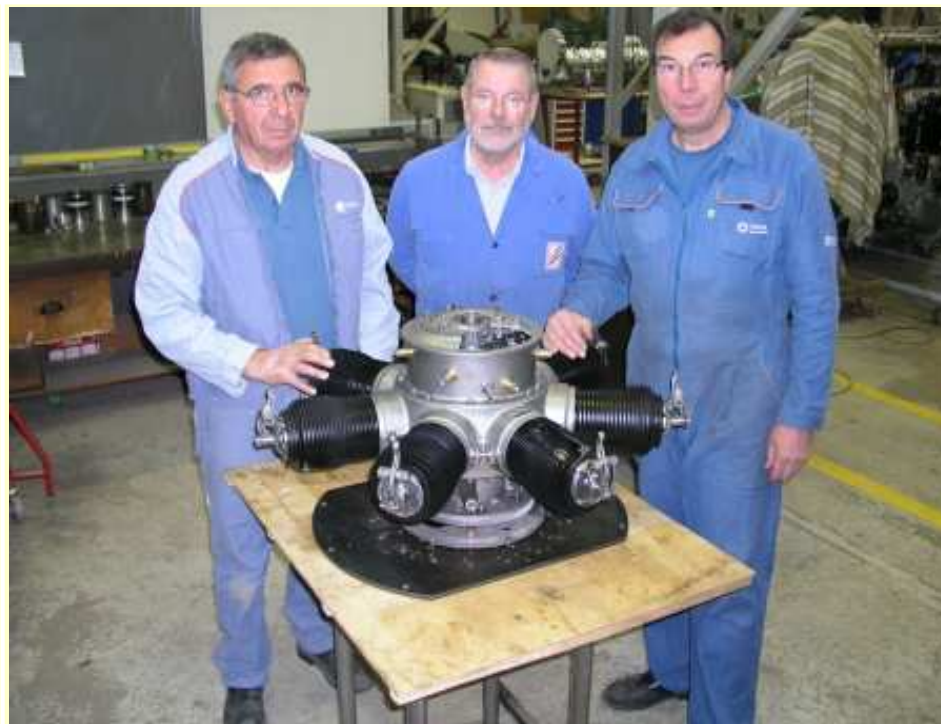
Moteur Gnome mono-sopape 7 cylindres 1912 après restauration
