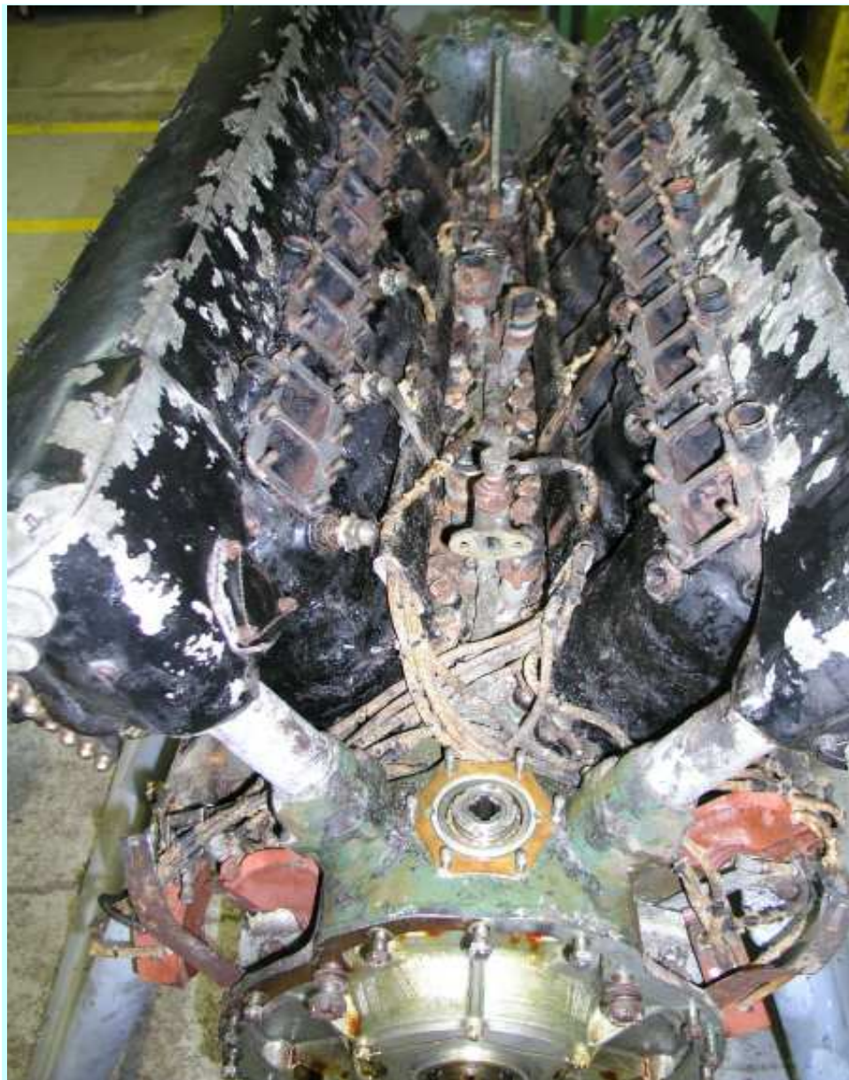
Le moteur Renault 12 cylindres pris pour restauration (14-12-2011)
