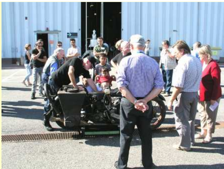
Moto G&R à gazogène: il faut faire chauffer le foyer alimenté au charbon de bois.
