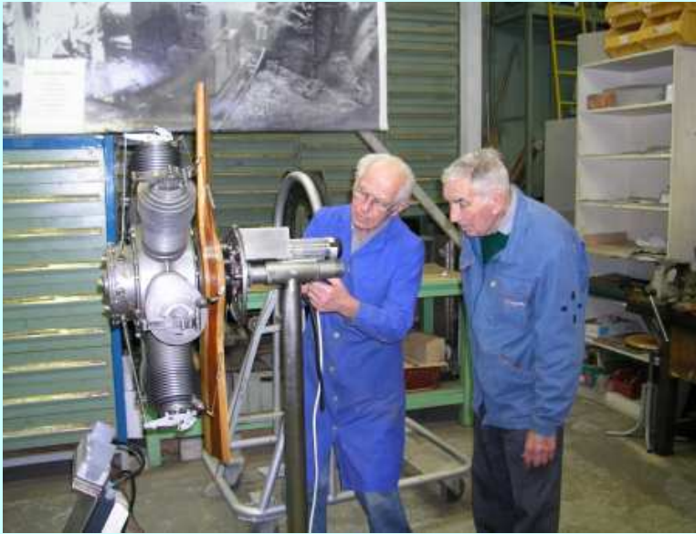
Remise en état du Gnome servant aux expositions externes (nov. 2012)
