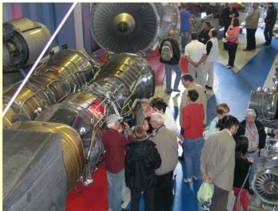
Explications sur les moteurs Olympus 593 de l'avion supersonique civil Concorde
