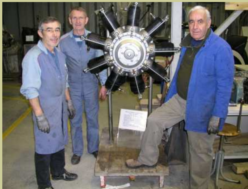
Moteur Gnome 9 cylindres mono-soupape restauré (29-02-2012)
