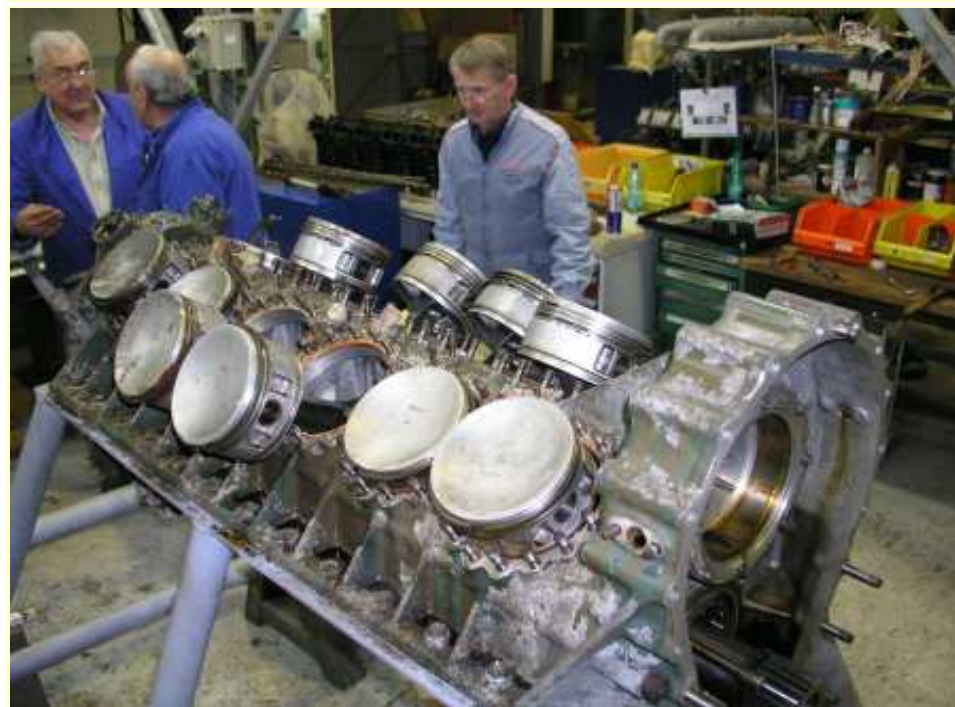
Renault 12 cylindres en cours de démontage (07/03/2012)
