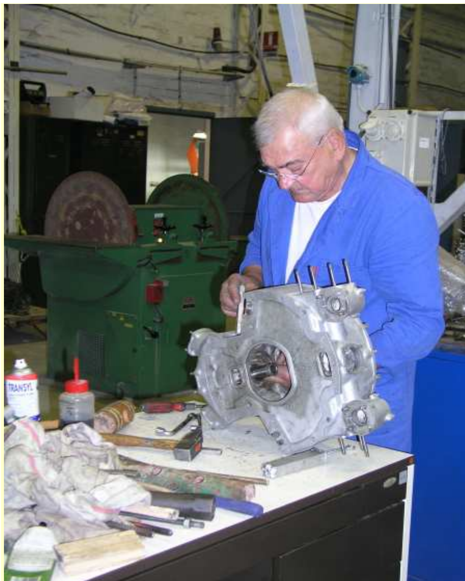
Renault 12 cylindres- nettoyage des pièces une par une (16/05/2012)
