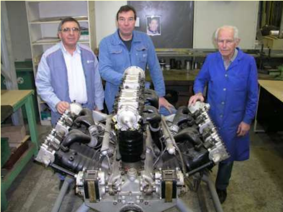
Moteur Lorraine12 Eb 450ch 12 cylindres en W, identique à celui de "L'oiseau blanc" de Nungesser & Coli à restaurer - Rappel: vol traversée de l'atlantique le 08 mai 1927 (12/12/2012)
