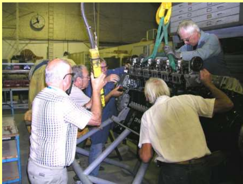
Moteur Junkers: remontage délicat d'une culasse (septembre 2013)
