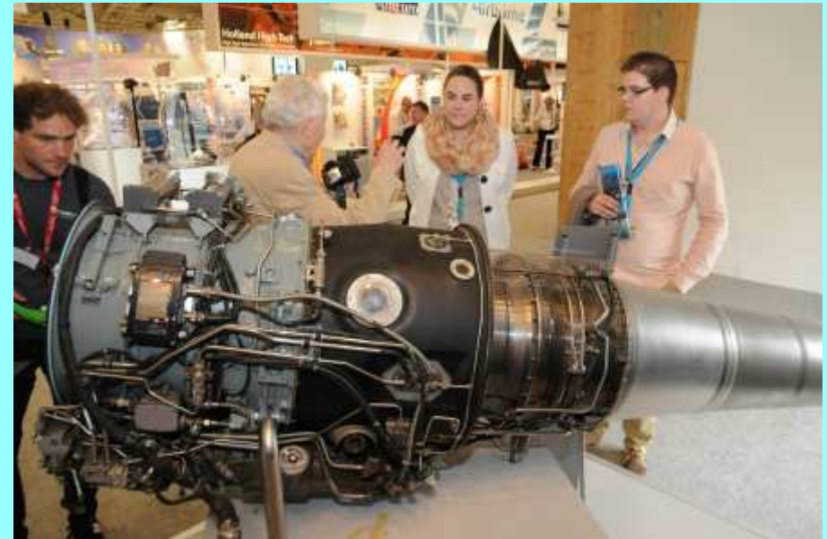
Le moteur Larzac en coupe exposé sur le Stand du Musée Safran en plus du Gnome Oméga et du démarreur Noelle
