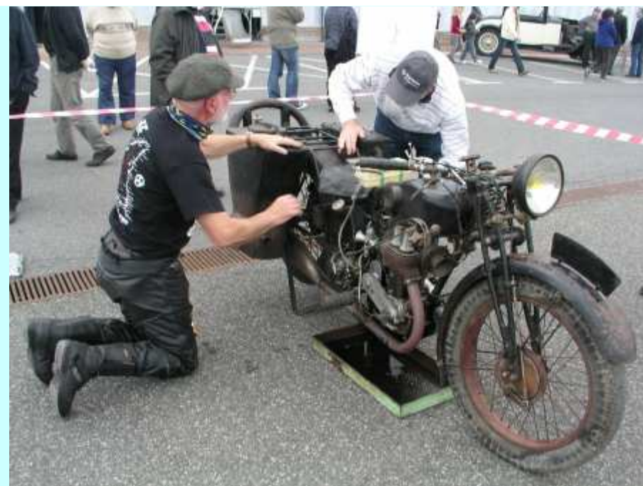
La moto G&R gazogène en cours de mise en chauffe du foyer
