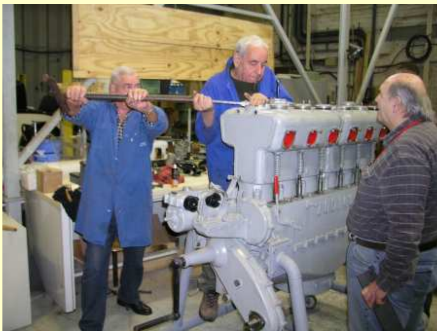
Moteur Zodiac MAE N° 1146 - 6 cylindres en ligne (27/03/2013)
