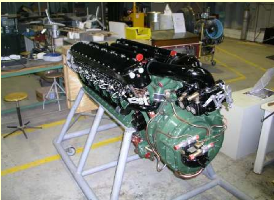
Moteur Junkers MAE N° 1406 (1942 - 12 cylindres en V - 1850ch) en restauration (20/02/2013)
