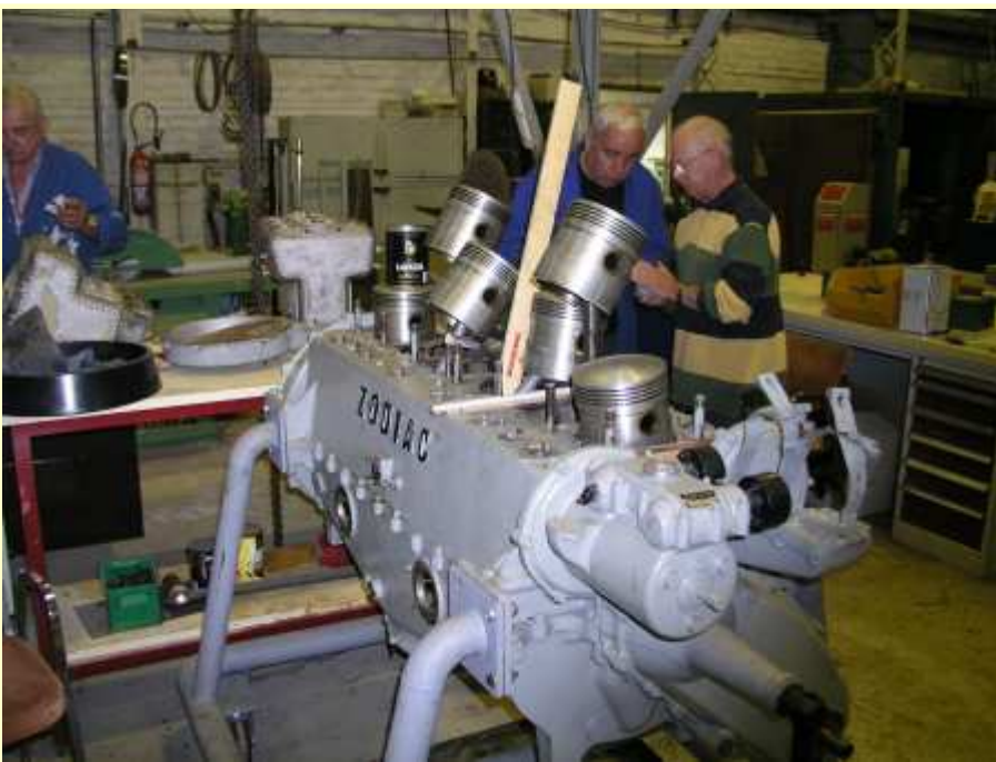
Moteur Zodiac MAE N° 1146 - 6 cylindres en ligne 220 ch (le 24/04/2013)
