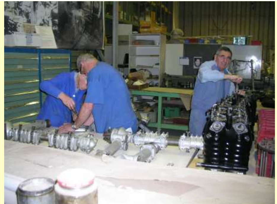
Moteur Lorraine 12 EB 1924 -450ch - 12 cylindres en W (le 24/04/2013)
