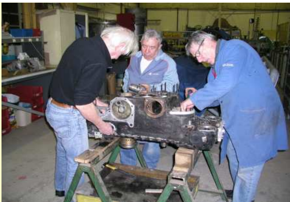
Moteur Junkers MAE N° 1406 (1942 - 12 cylindres en V - 1850ch) en restauration (20/02/2013)
