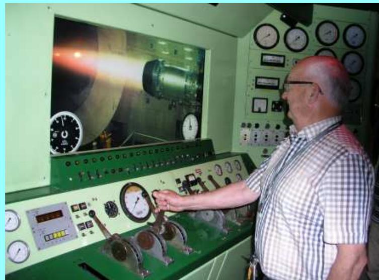
Le banc d'essai du musée permet de voir et d'entendre le fonctionnement du turboréacteur M88 du ralenti moteur sec jusqu'au plein gaz avec rechauffe (03/08/2016)
