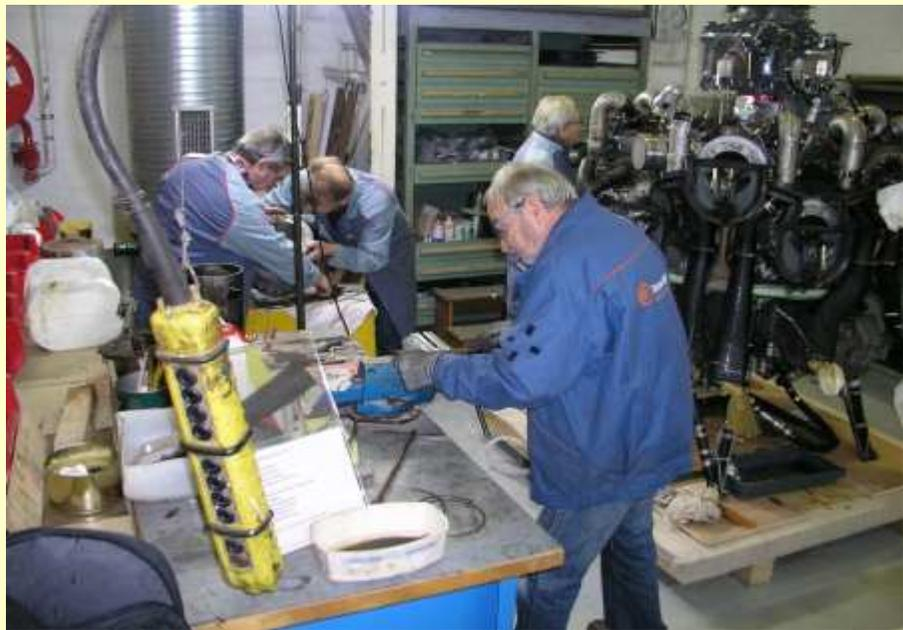
Moteur Hercules, le démontage des cylindres se poursuit (03/02/2016)
