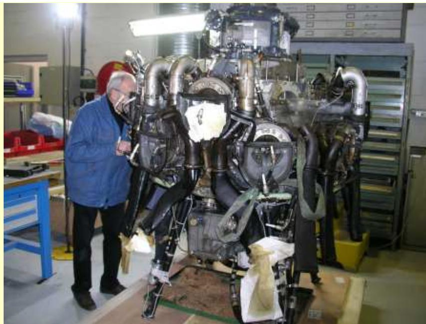
Moteur Hercules dans l'atelier pour révision: lubrification des cylindres (16/01/2016)
