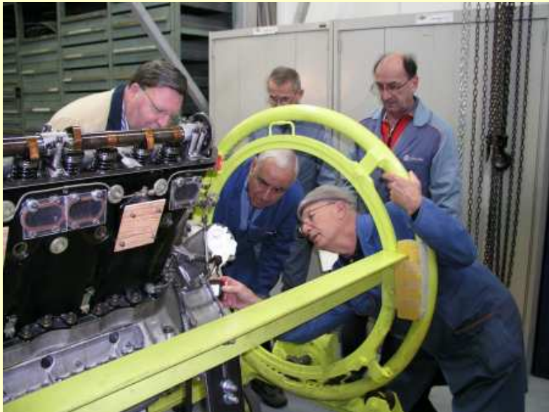
Moteur Saurer 12Y51: le calage de la distribution est une opération délicate (22/02/2017)
