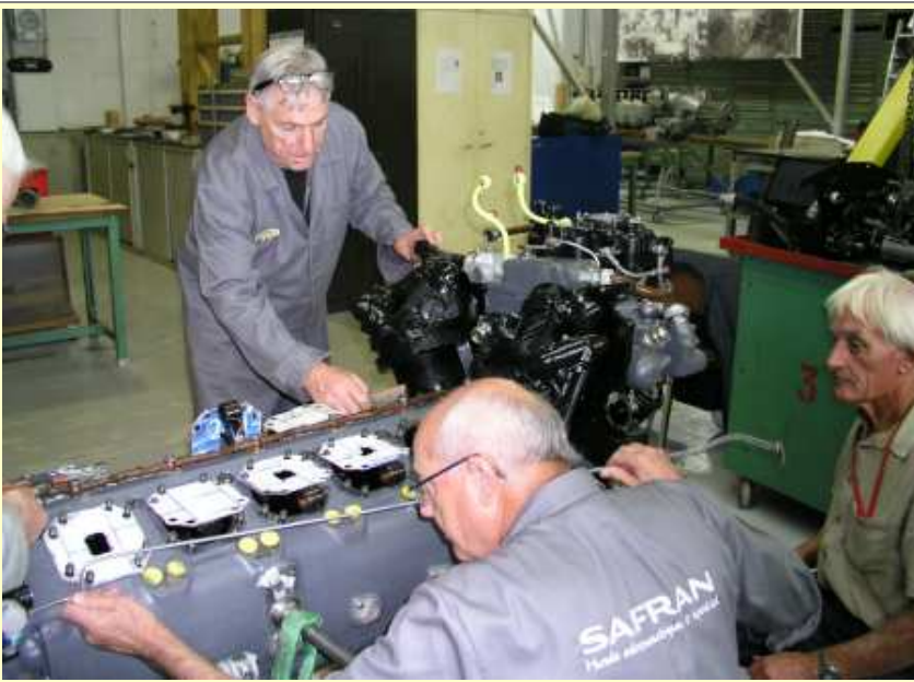
Renault 12 T début de remontage des cylindres (23/08/2017)
