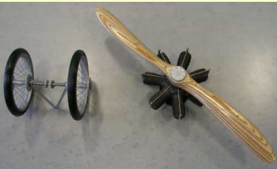
Moteur et train d'atterrissage pour la maquette de l'avion Caudron G3 réalisés, sauf l'hélice, avec l'imprimante 3D du CE de Villaroche (15/02/2017)
