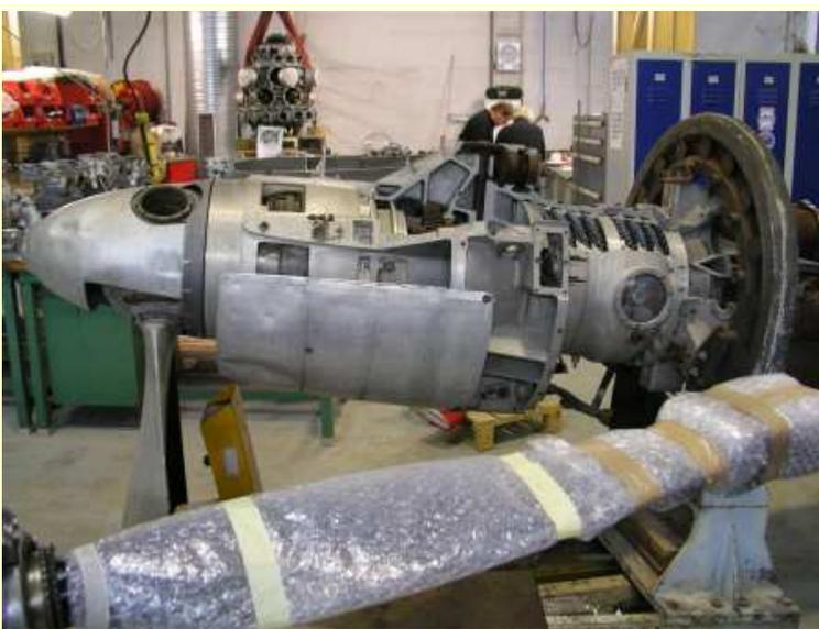
Turbopropulseur Snecma TB 1000 de 1947 (un exemplaire a tourné au banc à Villaroche 1280 cv - 480 Kg sans hélice) à restaurer origine AAT (14/11/2018)
