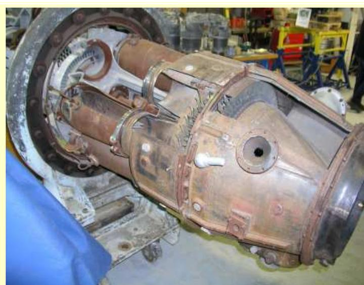
Ce TB 1000 de conception Rateau est un exemplaire unique (compresseur axial de 9 étages - 6 tubes à flammes - turbine à 2 étages - tuyère d'éjection - réducteur d'hélice)
