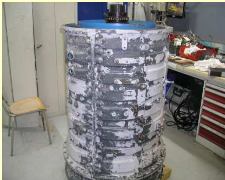
Démontage de l' ATAR 9B , carter compresseur (19/03/2019)
