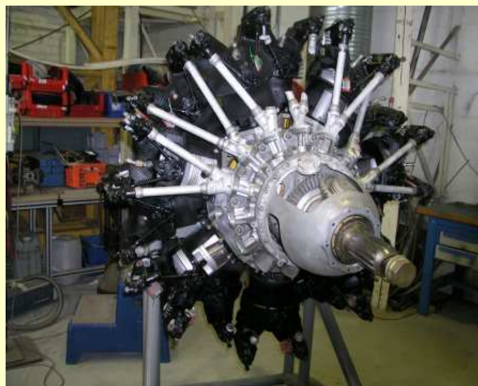
Restauration en cours du G&R 14N (19/03/2019)
