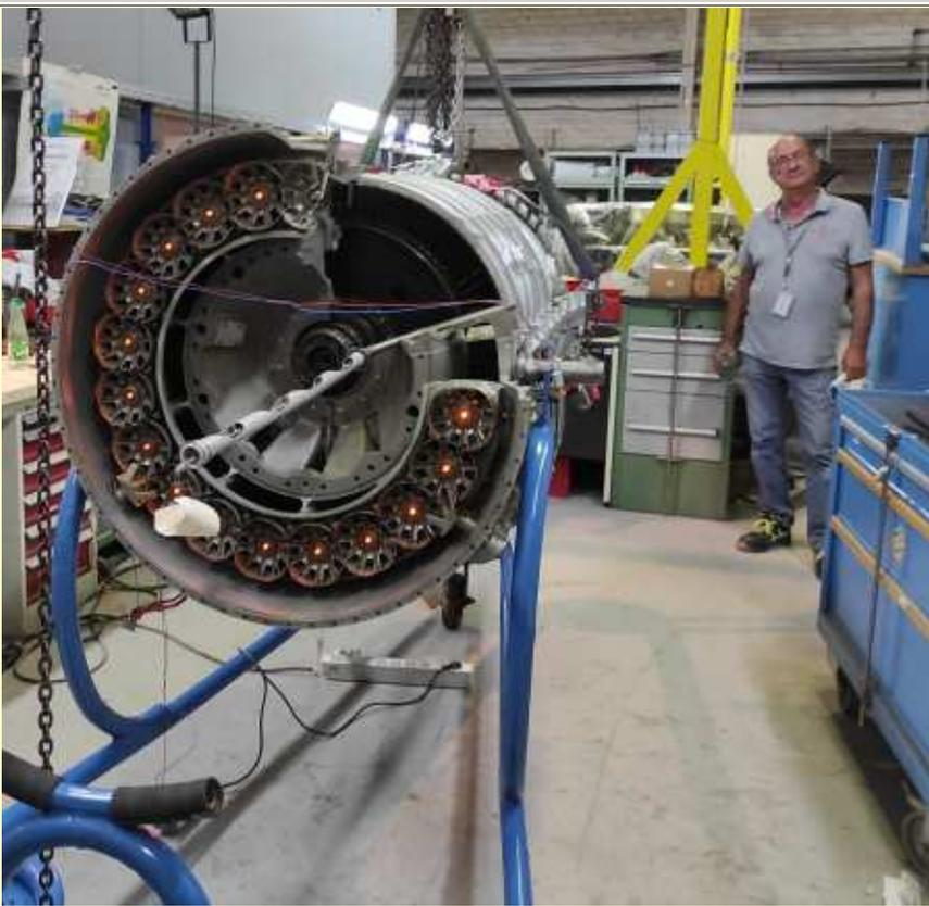
ATAR 9B, injecteurs de la chambre de combustion avec leds (11/08/2021)
