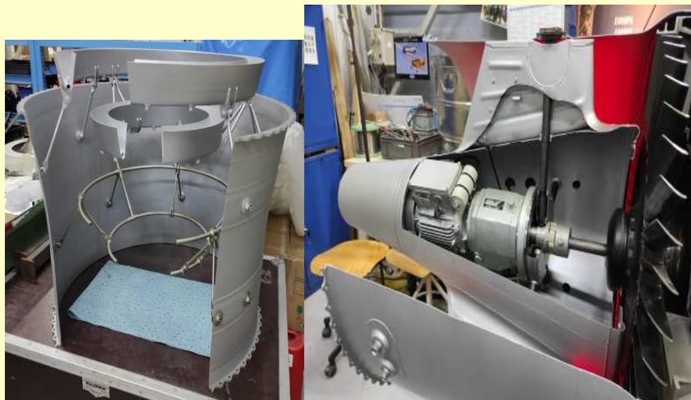
ATAR 9B rechauffe et moteur électrique dans le cône AR (29/06/2022)
