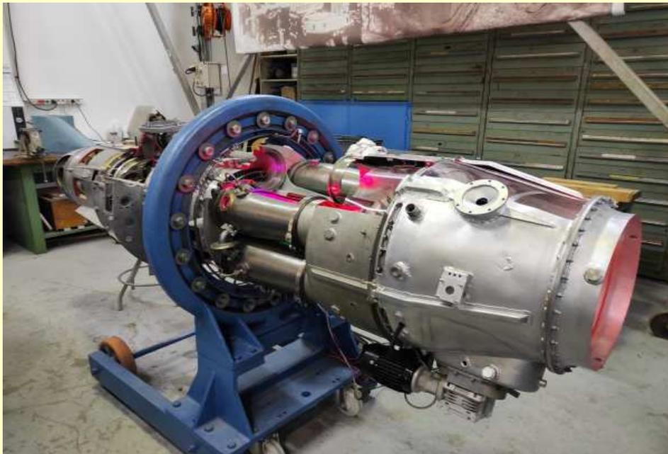
Atelier TB 1000 installation d'un moteur électrique pour faire tourner le rotor (15/11/2023)
