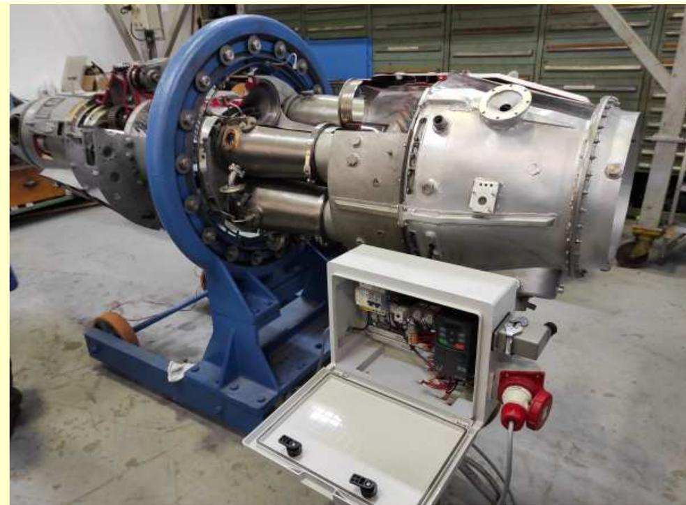
Atelier TB 1000 boîtier de commande du moteur électrique (15/11/2023)
