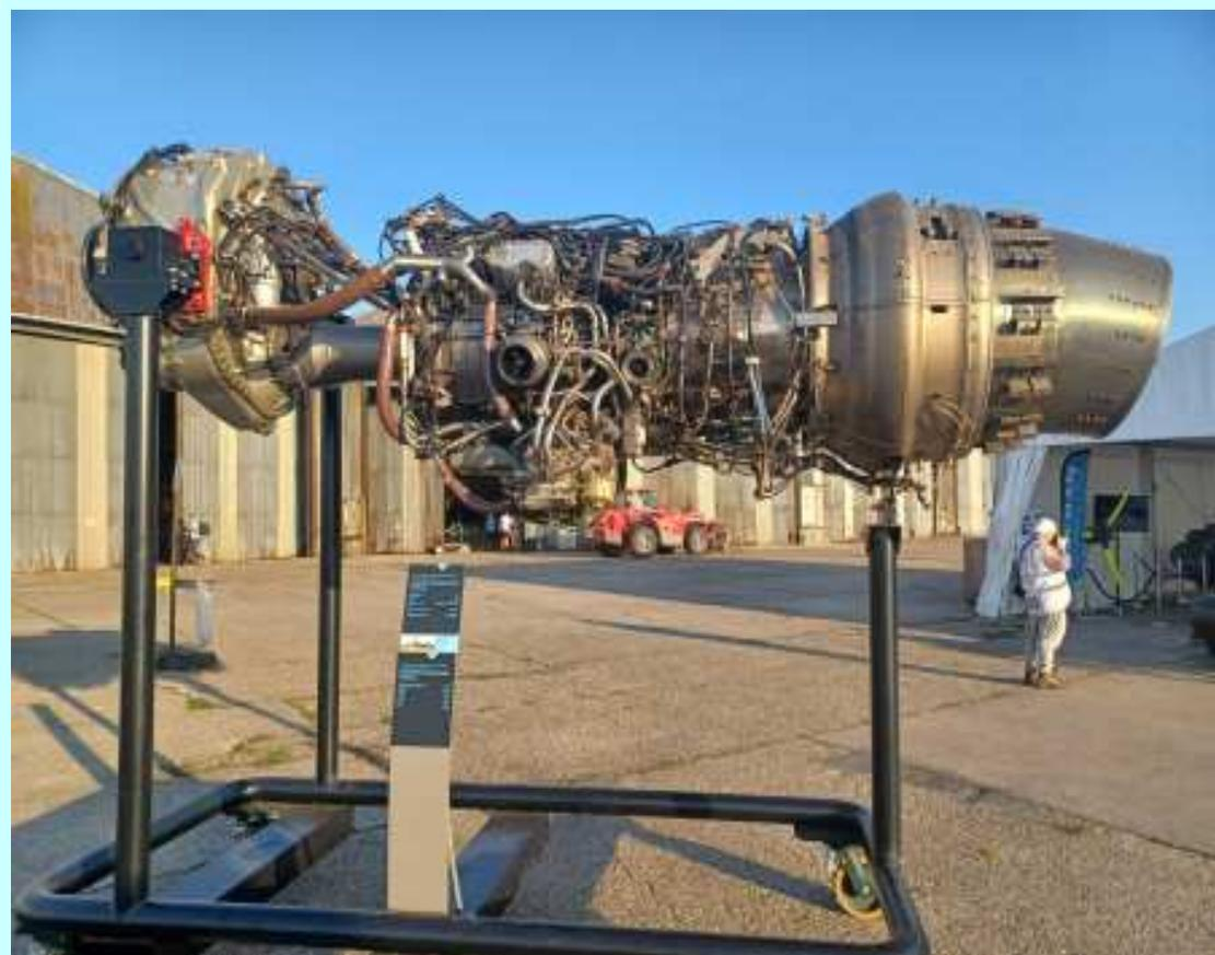
Turbopropulseur TP400-D6 de l'Airbus A400 Atlas à Air Legend
