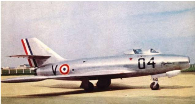
Dassault MD-452 Mystère II A-04 codé " V " avec des bidons très fuselés en saumon d'ailes d'une contenance de 150 litres (© Dassault Aviation). Dernier appareil à porter l'appellation " prototype ", le A-04 participe à la mise au point des versions Atar 101 C puis D et E et atteint 50 000 ft (15 000 m) durant l'un des vols.
