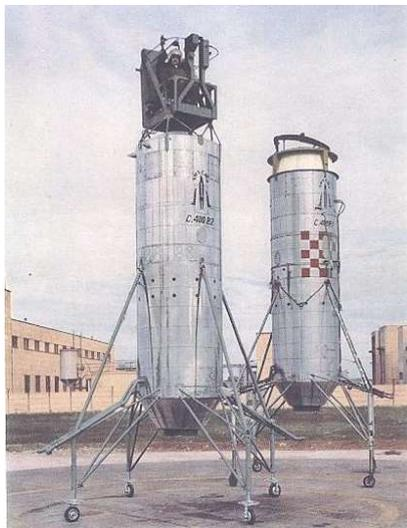
Les deux Atar volants : C-400 P1 et P2 (1957). Les carreaux rouges sur le fuselage du C-400 P1 servent à suivre les mouvements de roulis.
