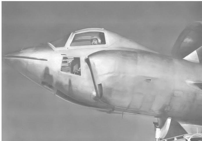
Le pilote à bord du C-450 " Coléoptère " et en position correspondant au vol en palier. Il dispose, pour la visibilité, de panneaux vitrés latéraux et de plancher en plus de la verrière.
