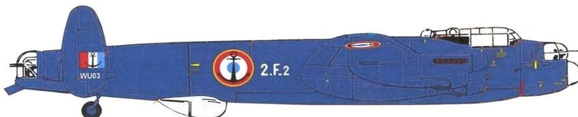
Avro 683 " Lancaster " B Mk.1 - Flottille 2F (@ DR). Anciens appareils de la RAF, livrés en deux versions B Mk.1 (32 exemplaires) et B Mk.7 (22 exemplaires), ils font l'objet des modifications : suppression de la tourelle dorsale, adjonction d'un réservoir de carburant dans la soute à bombes, ajout d'un bateau de sauvetage.
