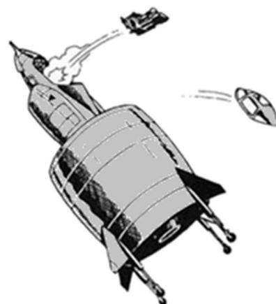
à l'ensemble une position de descente favorable. L'autre dispositif règle le retardateur d'éjection de masselotte et d'extraction de la voile individuelle à 4 secondes, permettant un moindre choc aux grandes vitesses.
