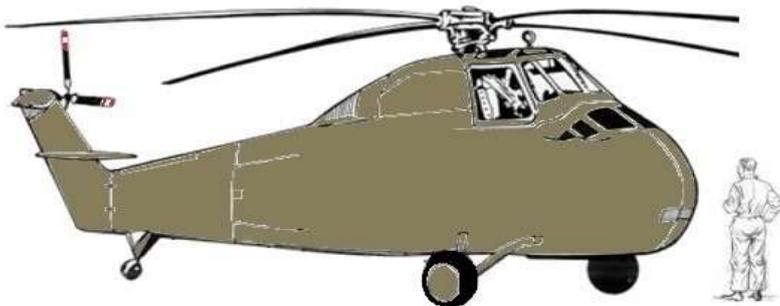
Sikorsky S-58. Surnommé " l'avion à plumes " par les combattants français durant la guerre d'Algérie, il comporte un rotor quadripale mû par un moteur Wright R-1820 de 1 525 ch installé (à 45°) dans le nez.
