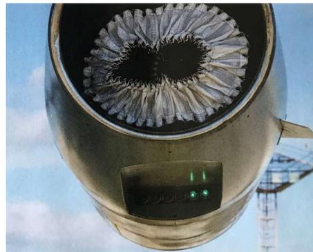
Nacelle de ravitaillement en vol Mk.32B-551 (© AAE)
