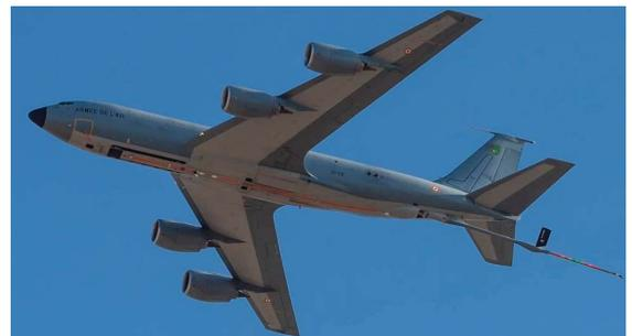
Boeing C-135 FR F-UKCE sn 63-8474 avant installation des nacelles de bout d'aile. La perche centrale est de type rigide "Flying Boom" (©AAE)
