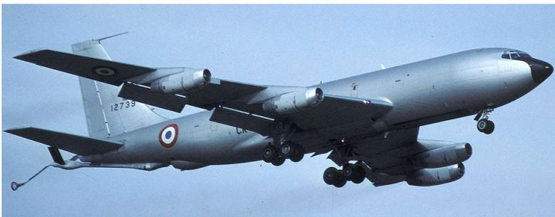
Boeing C-135 F (F-UKCK) sn 63-12739 au décollage. La perche de ravitaillement empennée possède un débattement de + 10° et - 50° en élévation et + ou - 15° en latéral. (© AAE)
