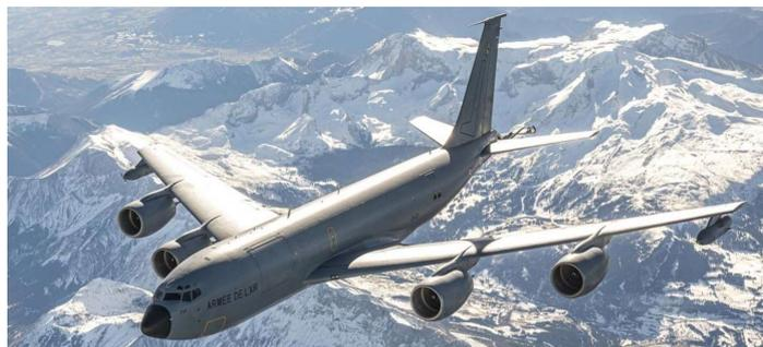
Boeing C-135 FR avec les nacelles de bout d'aile Cobham Mk 32B-551 à tuyau souple et panier (*Probe and Drogue*) capables de transférer jusqu'à 1275 kg/min. Le premier avion modifié est arrivé en France en février 1994.
