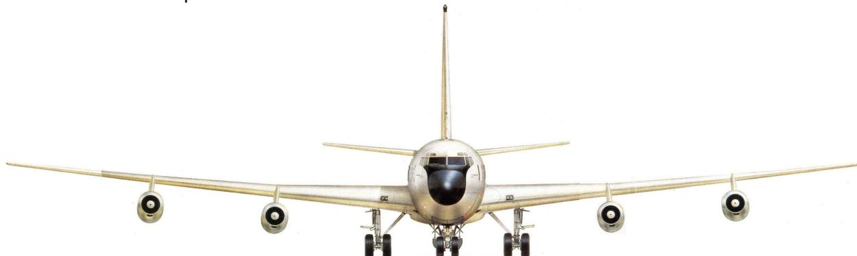
Boeing C-135 F : un appareil imposant par ses dimensions avec ses 41,5 m de long, 12,80 m de haut et 40 m d'envergure en flèche de 35°. La cabine présente de respectables dimensions : 24,60 m de longueur, 3,30 m de large pour 2,10 m de hauteur.
