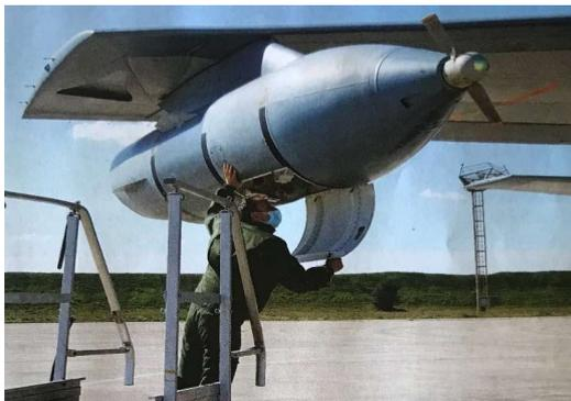
Nacelle de ravitaillement en vol Mk.32B-551 (© AAE)
