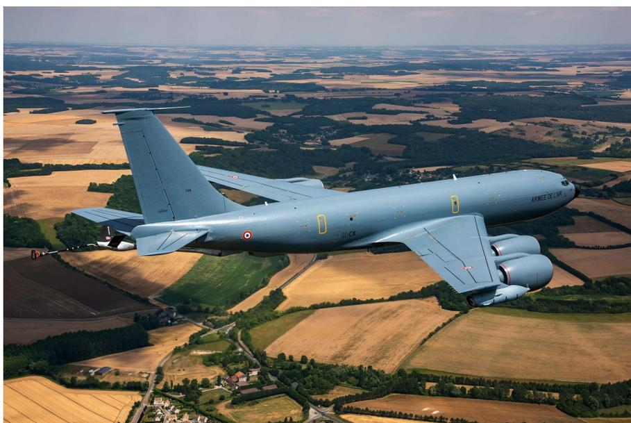
Boeing C-135 FR avec motorisation CFMI CFM56-2B1 (© Armée de l'air)
