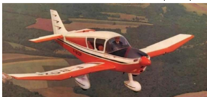
Robin DR-253 " Régent " F-BOZF n° 102 (3 pour trois roues). C'est le premier appareil à train tricycle et ailes entoilées du constructeur dijonnais alors troisième constructeur français derrière Reims-Aviation et la Socata. Le train tricycle facilite les décollages et atterrissages par vent de travers et assure un guidage plus précis au sol (1967). (@Archives Robin)
