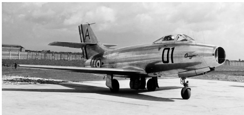
Dassault MD-450 " Ouragan " n° 13 alias " Atar 01 " (1953). A l'arrière du fuselage le " V " est la dernière lettre de son code d'identification radio et sur la dérive le " A " signifie Atar. (© Dassault Aviation)
