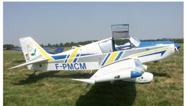
Jodel D-140 " Mousquetaire ". Avion d'aéroclub classique et de remorquage de planeurs, c'est le premier Robin du type quadriplace. Certains comportent une dérive en flèche, d'autres un empennage monobloc voire avec une verrière panoramique.
