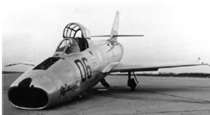
Mystère IV B-06 banc d'essai volant du propulseur Atar 8, peu après son atterrissage avec effacement du train avant (© Dassault Aviation)
