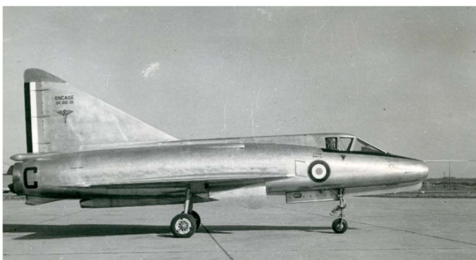
SNCASE SE-212 01 " Durandal " n°01, intercepteur léger à aile delta ayant servi à la mise au point de la régulation d'approche et de la postcombustion (PC) se l'Atar 9
