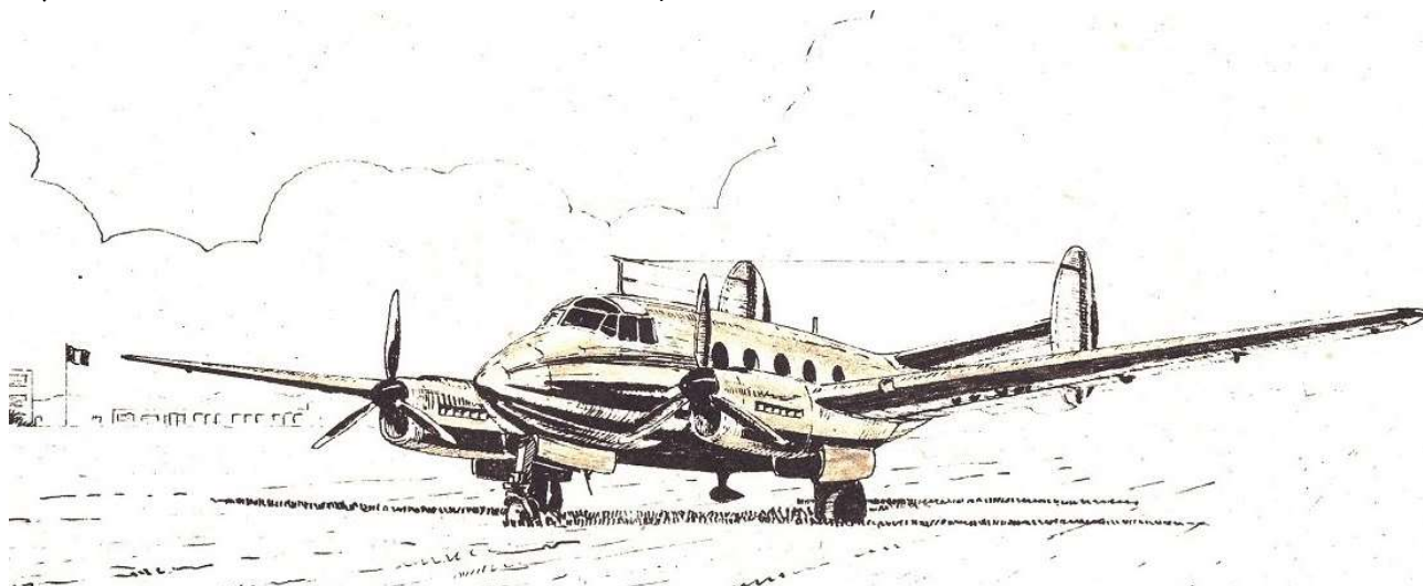
Dassault MD-315 " Flamant " (© DR). Roland Daney totalisa une trentaine de vols à bord du bimoteur de transport dans le cadre notamment d'essais de décrochages, de la mise au point des hélices réversibles, étalonnages, recherches de la vitesse minimale de contrôle (VMC).
