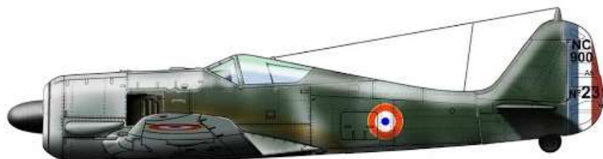
Focke Wulf Fw-190 type A-5 (alias NC-900) propulsé par un moteur BMW 801-D2 de 1 730 ch et 2 000 ch avec la surpuissance (@ War Drawings)
