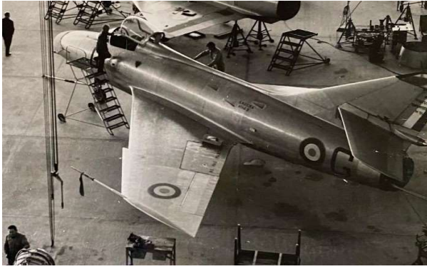
Super Mystère B4-01 banc d'essai volant du propulseur Atar 9 (1965) (@ Snecma)
