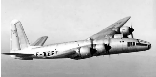
SNCASE SE-1010 n° 01 un avion photographique propulsé par quatre moteurs en étoile Sncma 14 R.
