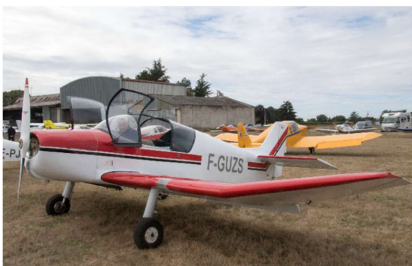
Jodel D-150 " Mascaret ". Dernier biplace de la formule Jodel (contraction de Joly-Delemontez) conçu pour le voyage aérien, c'est le premier appareil Robin avec empennage monobloc et dérive en flèche.
