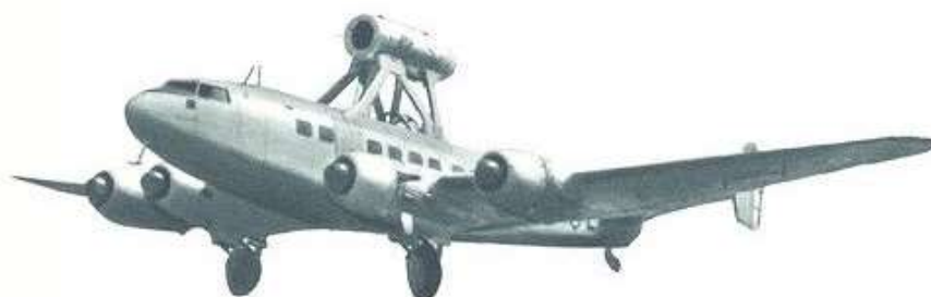
SE-161 " Languedoc " banc d'essais des réacteurs Atar 101 (Coll. J. Mesnard)
