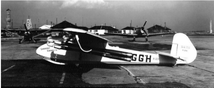
Arsenal SA-104 "Emouchet" n° 224 : un planeur qui décolle tout seul. Notez les entrées d'air des pulsoréacteurs courbées vers l'arrière.
