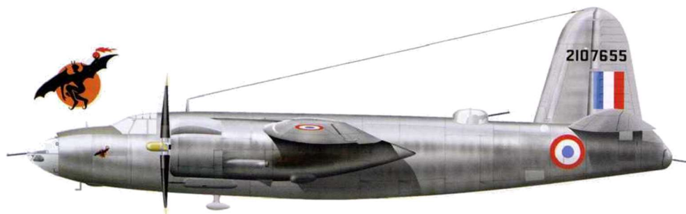
Martin B-26-C 45-MO " Marauder " serial 42-107655 - GBM 1/22 " Maroc " 1943 (@ DR). L'angle d'incidence de la voilure est de 3°5. Ce type fut le premier et le plus souvent à être engagé par les unités françaises.
