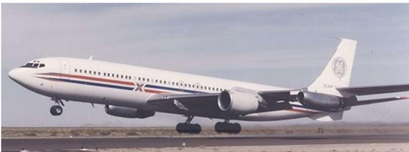
Boeing 707-321 c/n 17608 banc de test volant des CFM56-3 et -5. Ayant d'abord appartenu à la compagnie Pan American il est, par la suite, racheté par GE. La silhouette du quadriréacteur inaugure la formule de l'avion de transport commercial avec un fuselage en tube et moteurs en nacelle. (© General Electric)
