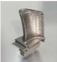
Ci-contre une aube de turbine HP mise au point au prix de millions de dollars. Un seul étage de turbine HP suffit à entraîner le compresseur HP.
