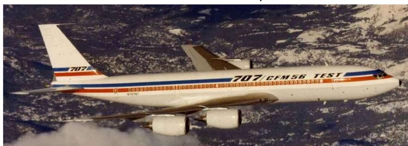
Pendant environ deux ans et demie, il totalise 220 heures dont environ 51 heures (en 32 vols) effectuées par les pilotes d'essais de la SNECMA, en 1980. Au cours des sorties le comportement vibratoire des nouveaux moteurs est constamment surveillé (3) et les inverseurs de poussée à grilles essayés avec plusieurs déploiements lors des atterrissages et dans des conditions identiques à celles d'un vol commercial. Le
