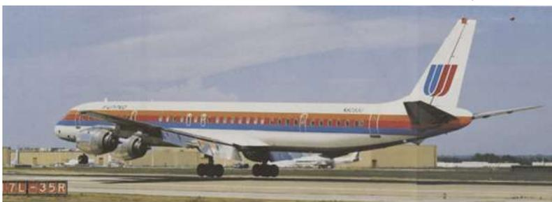
Douglas DC 8-71 United Airlines motorisé par quatre CFM56-2C (© DR). A noter les nacelles à flux séparés. Au moment de leur remotorisation, la plupart des appareils comptabilisaient entre 35 000 et 40 000 heures de vol (soit une estimation d'une vingtaine d'années d'exploitation), leur durée de vie étant d'environ 100 000 heures de vol.
