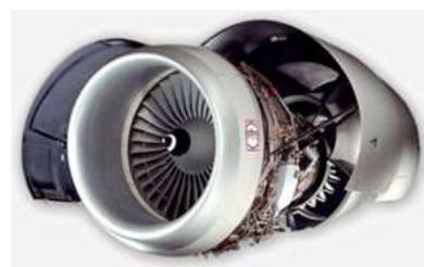
CFM56-5C4 équipé de sa nacelle. L'ensemble nacelle et inverseur pèse 500 kg (© SAE)
