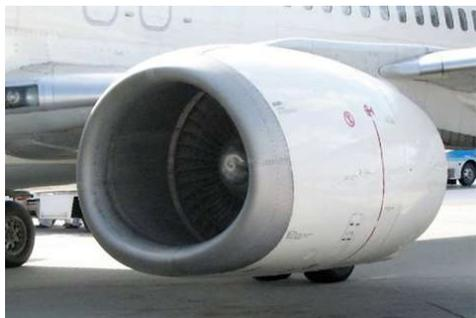
Boeing 737 " Classic " nacelle du moteur CFMI CFM56-3B. La forme oblongue de l'entrée d'air et la surface inférieure " aplatie " permettent une meilleure garde au sol.
