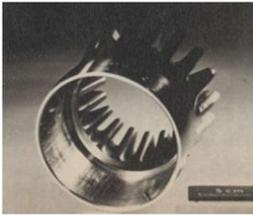
Mélangeur à 18 lobes. Le flux chaud du générateur de gaz circulant de gauche à droite, à l'intérieur de la virole, est projeté radialement vers le flux secondaire, froid, auquel il cède une partie de sa température. En aval du système, la tuyère terminale tranquillise l'écoulement mélangé avant éjection des deux flux. (© SAE)
