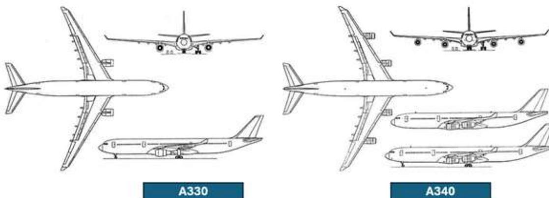
Comparaison configuration bi moteur et quadri moteur
