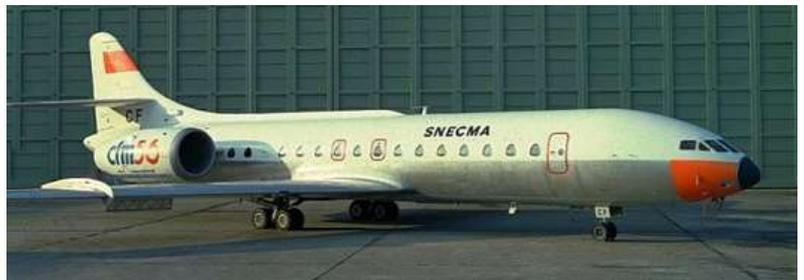
L'équipement d'essai embarqué permet de recueillir simultanément 350 paramètres et de simuler les prélèvements d'air - sur les étages 5 et 9 du compresseur HP - ainsi que les prélèvements mécaniques, le relais d'accessoires entraînant une pompe hydraulique de grande puissance. Le réacteur gauche Rolls Royce " Avon ", lui, assure les servitudes propres à l'avion lui-même.
