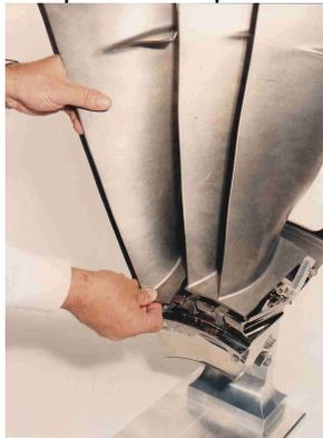
Risque d'impact du bord d'attaque des aubes de soufflante du CFM56-3
