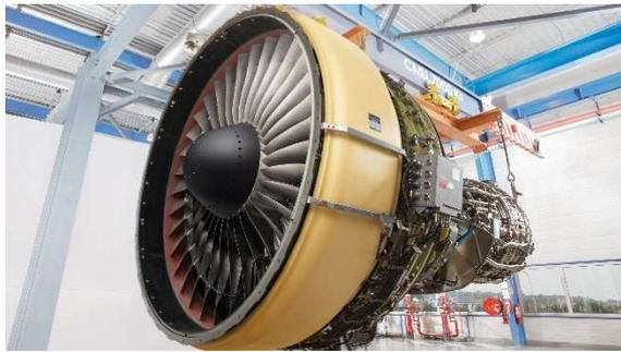
General Electric CF6. Moteur CF6-80 C2/F double flux capable de 70 000 livres de poussée à contrôle FADEC.
