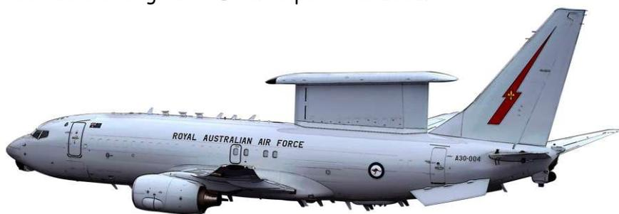
Boeing E 7A " Wedgetail " propulsé par une paire de CFM56-7B aux couleurs du squadron 2 de la Royal Australian Air Force. Avion de veille aérienne, il comprend une cellule et une aile de BBJ et dispose d'un système radar fixe monté sur la partie supérieure du fuselage. (© Boeing)
