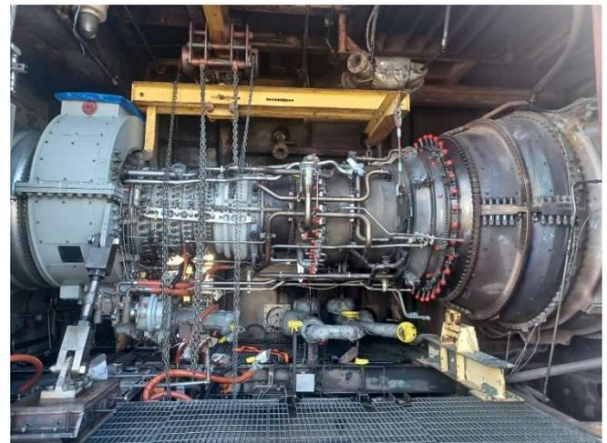
LM5000. Cette turbine développe jusqu'à 50 000 chevaux avec 38% de rendement thermique elle est disponible pour des applications marine et terrestre, elle dérive depuis 1977 du turboréacteur CF6-50.
