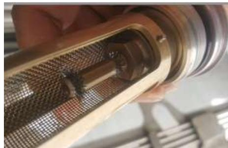
Particules magnétiques capturées par un barreau de branche.
