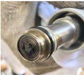
Particules magnétiques capturées par un barreau électromagnétique.
