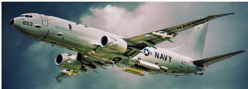
Les CFM56-7B qui propulsent les P-8 " Poséidon " diffèrent de leur version civile, notamment par la présence de générateurs électriques deux fois plus puissants, en fournissant 180 kVA par moteur. Dérivé de l'avion de ligne Boeing 737, le biréacteur de patrouille maritime et de lutte anti sous-marine qui pèse 85 tonnes peut atteindre la vitesse de 908 km/h et embarque un équipage de 9 hommes (2 pilotes et 7 opérateurs systèmes).
