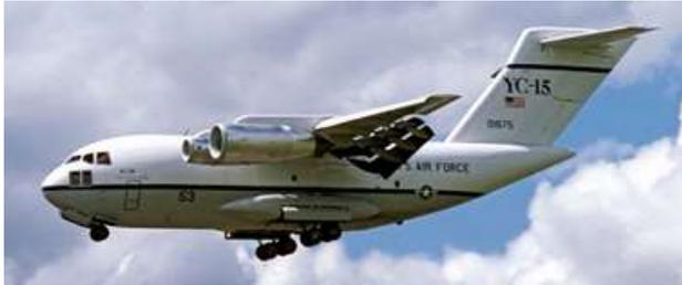
Sur l'avion-cargo militaire STOL (Short Take-off and Landing) YC-15, le vol inaugural du 16 février, d'une durée de 2 heures et 4 minutes, permet de valider les performances initiales. Par la suite, l'appareil sert à démontrer la compatibilité d'un réacteur double-flux, à taux de dilution élevé, à la technique de soufflage direct des volets (Under Side Blowing) employée pour rendre l'avion ADAC (Avion à Décollage et Atterrissage Court) (2).
