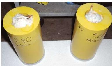
Oiseaux dans un cylindre en polyéthylène expansé prêts pour la mise en place dans le canon multitube avant la projection dans le moteur ou la soufflante à tester. La masse de chacun des oiseaux est mentionnée ainsi que la couleur du tube du canon sont précisées sur les cylindres pour s'assurer au bon point d'impact de la masse souhaitée.
