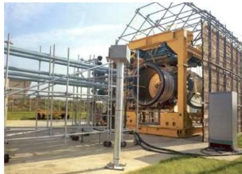
CEPr de Saclay : banc d'ingestion en plein air. Le CFM56 est positionné en face du canon multitube.
