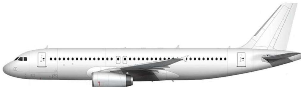
Airbus A320 (© Airbus). Le CFM56-5A est le moteur de lancement de la gamme A320. Le biréacteur joue la carte technologique avec une avionique " tout écrans " qui présentent la totalité des des informations nécessaires au pilotage, la gestion du vol, et met en œuvre des commandes de vol électriques. En outre, l'introduction de matériaux nouveaux permet d'obtenir un gain de masse qui, associé au CFM56-5, procure aux compagnies aériennes une économie non négligeable des coûts d'exploitation.
