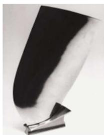
Aube de soufflante creuse en flèche à large corde
