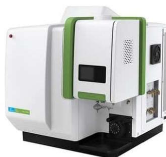
Spectromètre plasma destiné à l'analyse spectrométrique d'huile de lubrification.
