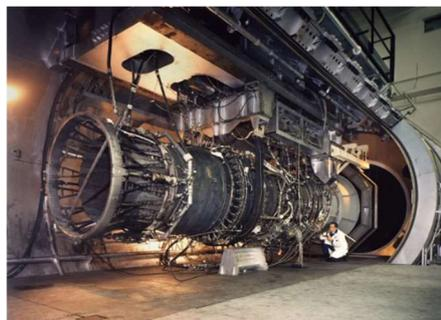
General Electric GE-4. Moteur simple flux de très grande puissance destiné au Boeing 2707 SST. 68,600 livres de poussée avec post combustion.
