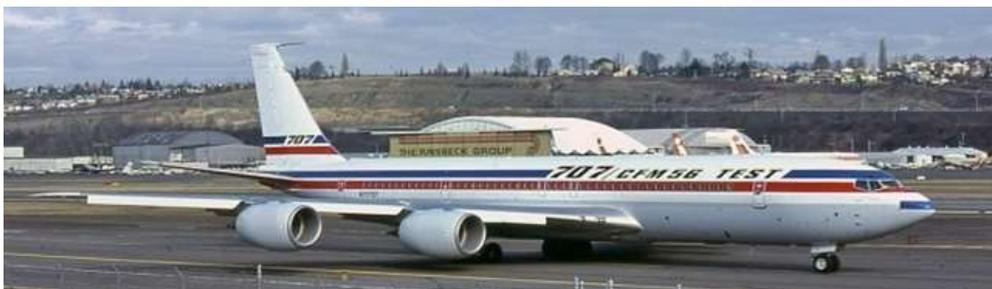
Boeing 707-700 c/n 21956 (N707QT) rouge, blanc et bleu, banc de test volant du CFM56-2. La garde au sol avec les CFM56, placés plus en avant et plus haut sur l'aile permet le décollage et l'atterrissage en toute sécurité. (© Boeing)
