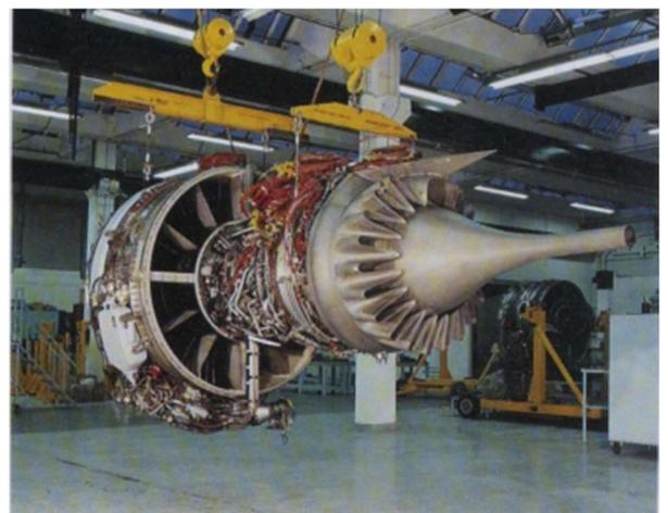
Le CFM56-5C2 est équipé à l'arrière d'un mélangeur (mixer) qui permet une meilleure interpénétration entre les flux chaud et froid et améliore la consommation en vol de croisière. (© SAE)
