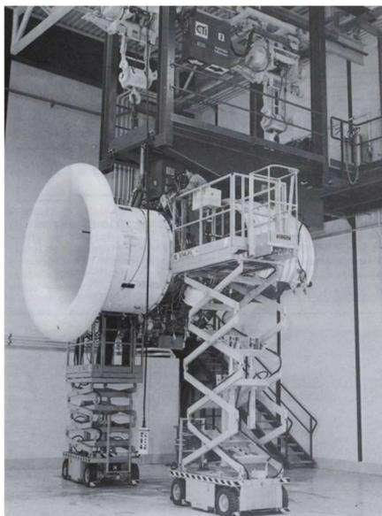
La veine du banc d'essais 1S10 : grandes dimensions, accessibilité au moteur (ici un CFM56-2) facilitée par le plancher élévateur, les nacelles mobiles de chaque côté et le système de branchement automatique.
