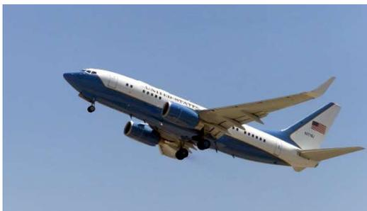
Version militaire de l'avion de ligne 737-700 (fuselage) sur lequel ont été ajoutés les ailes et le train d'atterrissage du Boeing 707-800, le Boeing C-40 " Clipper " est mis en service le 21 avril 2001. Il est utilisé à la fois par l'United States Navy et l'Air Force et le Marine Corps.
