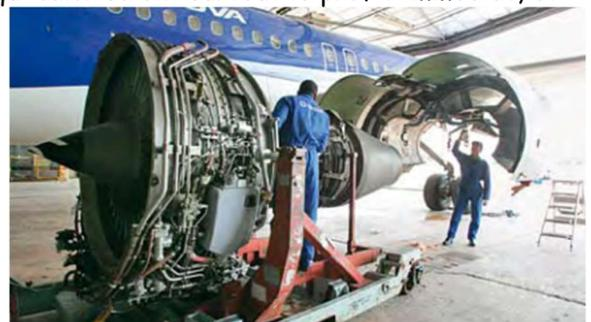
Inspection d'un CFM56-5B équipant un Airbus A320
