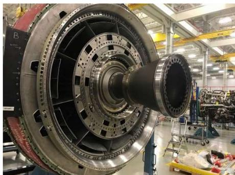
Monté à la face avant sur le carter supportant la soufflante, vue du dispositif réducteur de charge, notamment le support du palier un à rouleaux dont on aperçoit la piste intérieure. A la périphérie extérieure de la cavité, le bord
