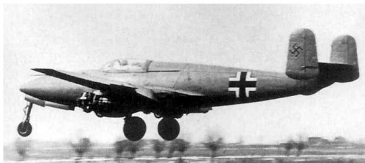
Heinkel He 280. Premier vol avec les capots moteur retirés à la dernière minute à cause d'une fuite de carburant d'une des tuyauteries de ses moteurs He-S8. Photo crédit internet.
