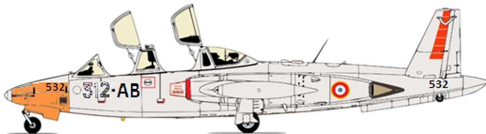
Fouga CM-170 R Magister n° 532 312-AB (1967 - 1976). L'avion est fini aluminium non peint. La peinture anticollision est appliquée sur la pointe avant et l'empennage, à l'intrados et à l'extrados. (© Auteur)
