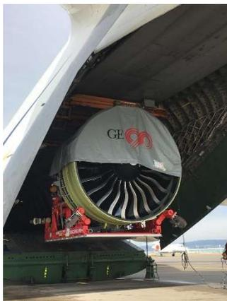
Chargement d'un GE90-115 B, en configuration M10, sur son bâti de transport, en position basse, dans un Antonov 124. Le chargement doit impérativement se faire turbine basse pression vers l'avant.
