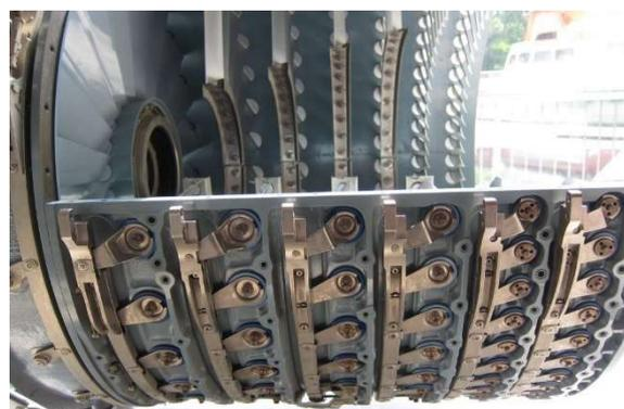
Demi carter de compresseur haute pression dont les stators sont à calage variable. Les anneaux ainsi que les leviers de commande des stators à calage variable sont bien visibles ainsi que les segments inférieurs lesquels forment un anneau, assurent l'étanchéité inter étage avec le rotor et le point d'appui des pivots inférieurs.
