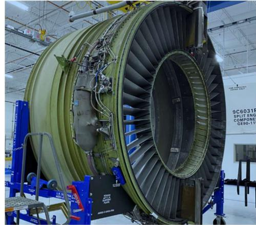
Module majeur carter de la soufflante du GE90-115 B sur son bâti de dépose/repose et stockage. On observe sur le côté droit le réservoir d'huile et au sommet, la tuyauterie d'amenée d'air chaud de dégivrage vers le bord d'attaque de l'entrée d'air. Photo origine internet.
