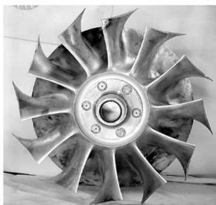
Vue d'une, des plusieurs définitions, testées de la roue de l'étage de " gavage " du dispositif de compression du moteur He-S11.
