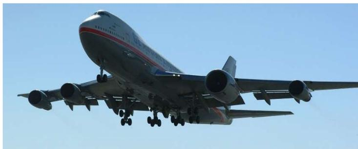
Décollage depuis le terrain de Mojave en Californie du Boeing 747-100 propriété de General Electric pour le premier vol du moteur GE90-115B installé en position 2.
