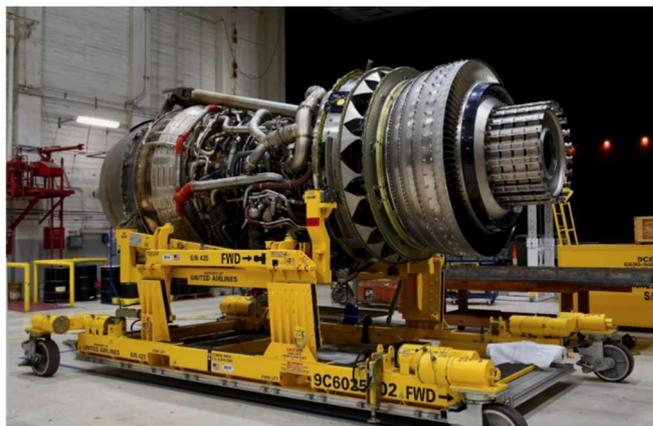
GE90-115 B en configuration M20 " Propulseur " sur son chariot de stockage, transport dépose/repose de l'avion. On observe sur le carter arrière de la soufflante, la couronne d'orifices destinés, en régime intermédiaire à l'échappement de l'air issu du compresseur basse pression vers le flux secondaire. Photo origine internet.
