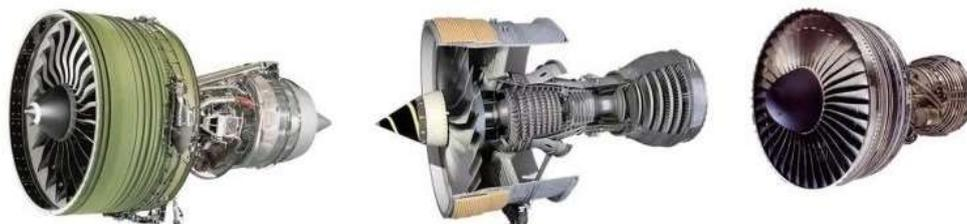
Moteurs équipant le Boeing 777 : General Electric GE90, Rolls-Royce Trent 800, Pratt & Whitney PW4000 (© DR)
