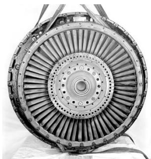
Heinkel He-S11. Vue de la roue de turbine du deuxième étage. Les cavaliers du dispositif d'interface d'étanchéité et de réduction des vibrations les axes de rétention sont bien visibles. Photo crédit archives de société Heinkel.
