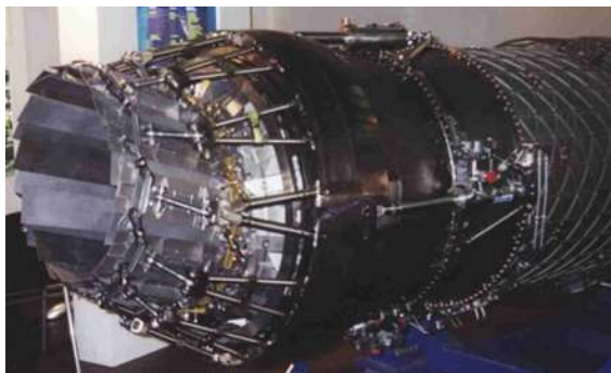
Tuyère vectorielle espagnole développée pour le moteur Rolls Royce RB-199 (© DR)
