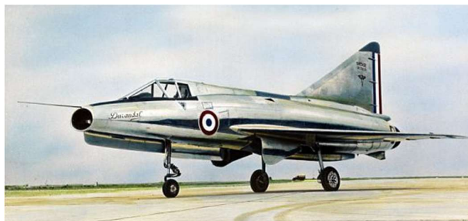
SNCASE SE-212 "Durandal" avec le nez plat et le culot courts, entrées d'air latérales de ventilation du tunnel réacteur noyées. Son train d'atterrissage s'escamote dans le fuselage vers l'avant. (© SAE)
