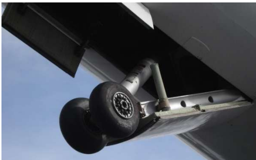
Atterrisseur arrière destiné à protéger le fuselage en cas de braquage exagéré de l'avion au sol (© DR)
