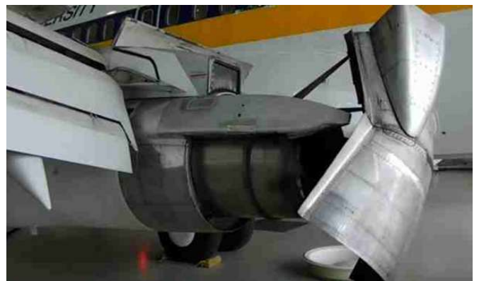
Inverseur de poussée "aval" du Boeing 737-200 (© DR)
