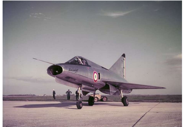
SE-212 " Durandal " 01 codé C (© Espace Patrimoine Safran). L'entrée d'air " longue " est dépourvue de cône générateur de choc oblique qui permet d'atteindre des vitesses supersoniques élevées.
