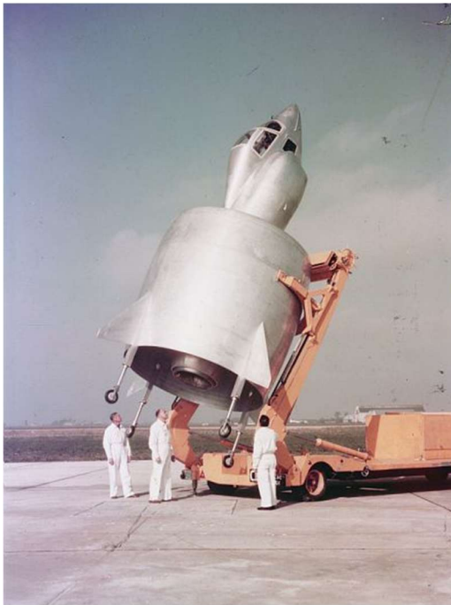
C-450 Coléoptère. " Sorte d'énorme manchon métallique d'où sort une capsule, le poste de pilotage, et qui se tient droit sur quatre frêles pattes métalliques. "
