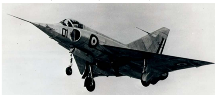
Dassault Mirage MD-550 Delta (Mai 1956). Le moteur fusée bi liquide SEPR 662 de type autonome c'est-à-dire qui possède sa propre turbine pour l'entraînement des différentes pompes est soigneusement " enroulé " sous et entre les deux turboréacteurs installés côte à côte Armstrong - Siddeley Viper A.S.V.5. (© Dassault Aviation)
