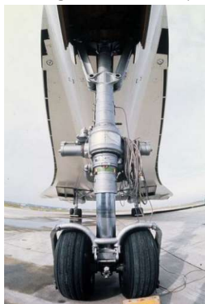
Atterrisseur avant avec sa protection contre les jets d'eau. Le relevage s'effectue en 7 secondes. (© DR)
