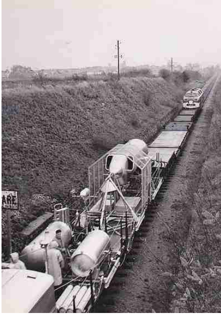
Essais d'atterrissage simulés du C400 P-3 installé sur un train
