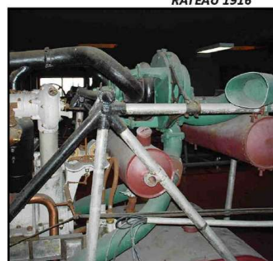
Principe du turbocompresseur Rateau et installation sur moteur Renault
