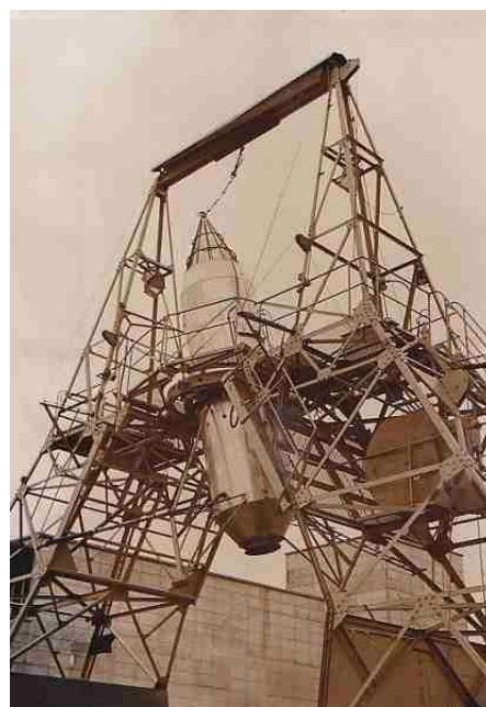
C400 P-1 en essais sur le banc gyroscopique (1956)
