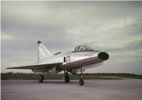
SE-212 " Durandal " 01 codé C (© Espace Patrimoine Safran). La voilure est en delta avec des extrémités arrondies.
