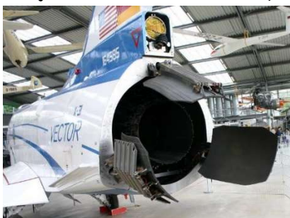
Dispositif " aval " d'orientation du jet d'un turboréacteur (© DR)
