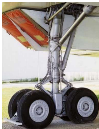
Atterrisseur principal avec ses déflecteurs d'eau. Le relevage s'effectue en 10 secondes. (© DR)
