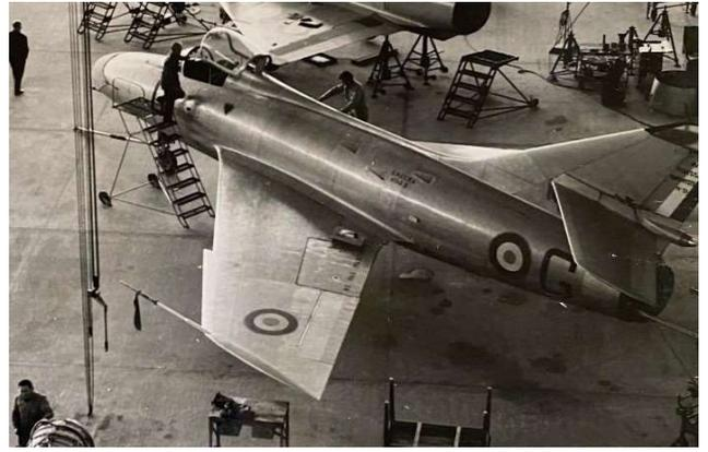
Super Mystère B4-01 banc d'essai volant du propulseur
