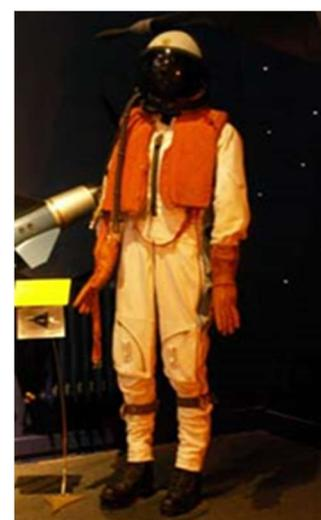
Combinaison de vol. Tout vol au-delà des 15 000 mètres nécessite l'emploi, par le pilote, d'une combinaison partiellement pressurisée, le vêtement haute altitude est appelé " l'habit de lumière ".
