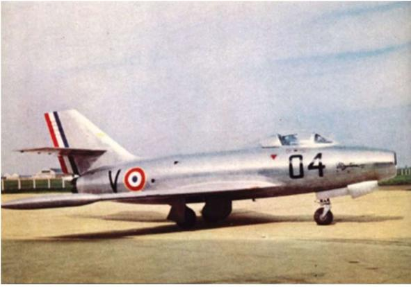
MD-452 Mystère II-04 avec réservoirs fuselés d'extrémités de voilure de 150 litres pour accroître l'autonomie
