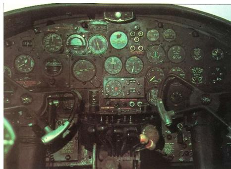
La disposition des instruments de contrôle et de vol sur le tableau de bord du B-25 facilitait le travail du pilote et du copilote, qui se répartissaient les différentes tâches.
