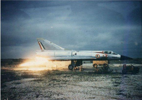
Mirage III C n° 4 avec moteur fusée SEPR 841 (© Snecma)
