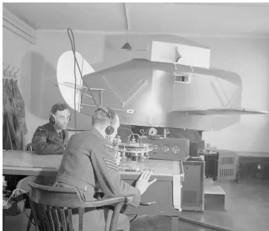
Formation au vol simulé à l'aide du simulateur Link. Un stagiaire qui vole à l'aveugle sous instruction sans fil à partir de la table de commande. Le parcours du vol est tracé sur une carte par la planchette sur la table devant l'instructeur au premier plan. (© DR)
