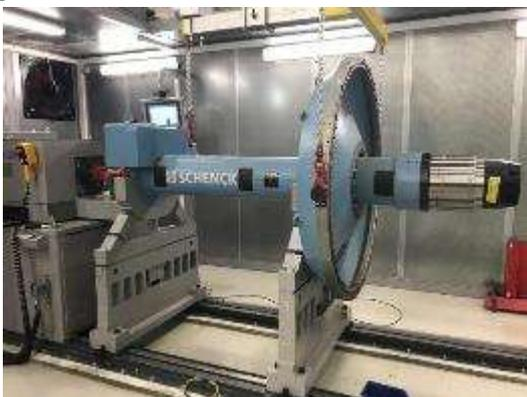
Équilibreuse (Schenck) pour rotors de grandes dimensions équipée pour l'équilibrage du compresseur basse pression du moteur Engine Alliance GP-7200 de l'Airbus A380.
