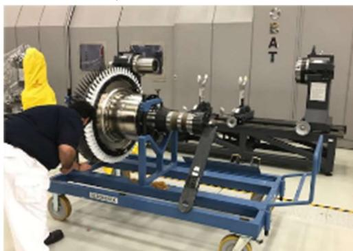
Un technicien prépare le rotor de turbine haute pression d'un moteur GE90-115 B pour installation sur une rectifieuse/équilibreuse à grande vitesse. Partiellement visible en arrière-plan.
