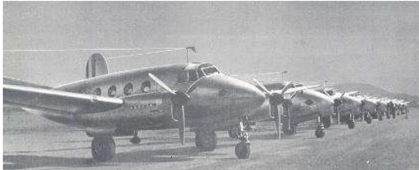
MD-315 "Flamant" (Mai 1955). (© DR). Comme tous les avions à hélices, le bimoteur dispose d'un pas d'hélice variable : petit pas pour les phases nécessitant une grande puissance (décollage, montée, atterrissage - pour une éventuelle remise des gaz), grand pas en croisière, et pas réversible qui permet, après l'atterrissage, de ralentir l'avion au sol par une poussée négative.
