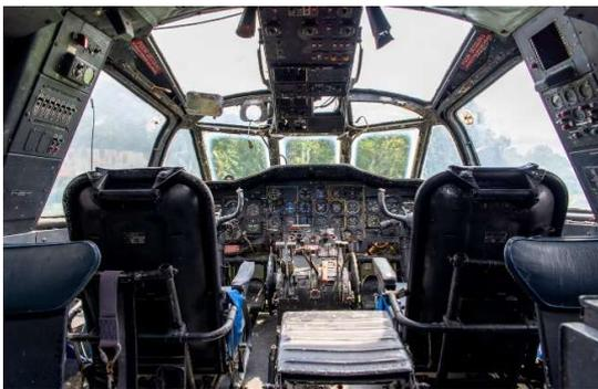
Nord 2501 n° 160 - Poste de pilotage. Sur le tableau de bord, les instruments ne sont pas les mêmes à droite et à gauche. La place droite n'est équipée que pour surveiller la navigation.
