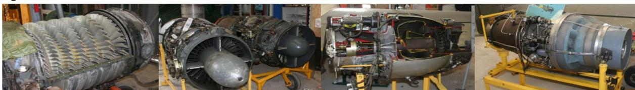
Réacteur axial simple corps simple flux SNECMA Atar 101 E et 101 G, réacteur centrifuge Turboméca Marboré VI (en coupe),
