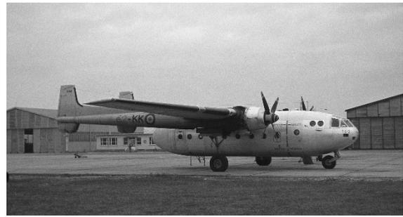
Nord 2501 n° 160 codé 62-KK - ET 2/62 " Anjou " (Collection G. Millas). Il est propulsé par une paire de moteurs à pistons en étoile Bristol " Hercules " 758/759 d'une puissance maximale unitaire de 1 040 ch.
