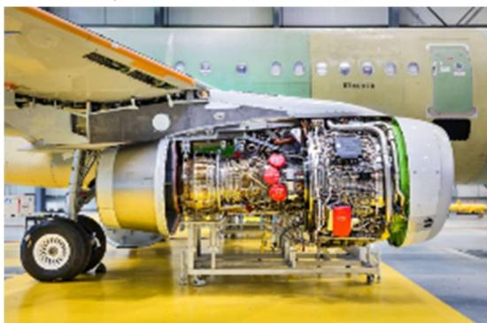
Moteur International Aero Engine IAE V-2500 tel qu'installé sur un avion Airbus de la famille A320. Les capotages de la soufflante et de l'inverseur de poussée déposés permettent de visualiser les accessoires.
