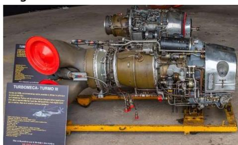
Turbomoteur Turmo III C7, turbopropulseur Bastan VII
