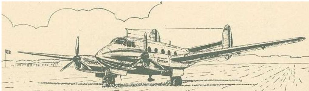
Dassault MD-315 Flamant I - Ecole de Rochefort-sur-mer (1953). Sa vitesse de croisière est de 260 km/h avec un maximum de 310 km/h et une autonomie moyenne de 4 h 15 min. Ses dimensions : envergure 20.21 m, longueur 12.58 m, hauteur 4.50 m.
