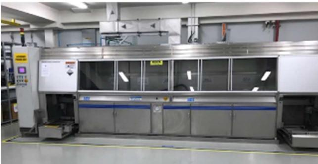
Chaîne automatisée (Finsonic) de nettoyage de roulements par ultrasons. *Photo collection privée.*
