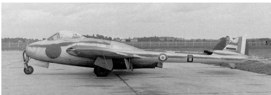
De Havilland Vampire Mk 5 n° 10119 codé D - Melun-Villaroche (1953) en configuration volets sortis. Le monoréacteur est dépourvu de siège éjectable et de dispositif de rallumage vol. La mise en œuvre du déviateur est réalisée avec une commande électrique et la visualisation est assurée avec un indicateur de position gradué de 0 à 10. (© Espace Patrimoine Safran)
