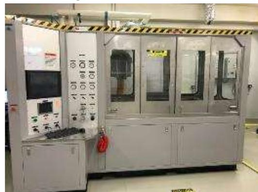
Machine (Bauerct) à vérifier les débits et pressions d'huile des boîtes d'engrenages de moteurs d'avion.
