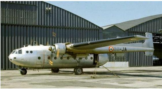
Nord 2501 n° 160 codé 88-JA - GAMOM 88. Camouflage de couleur aluminium avec la partie supérieure du cargo peinte en blanc pour réduire la température à l'intérieur des cabines. (Collection G. Millas)
