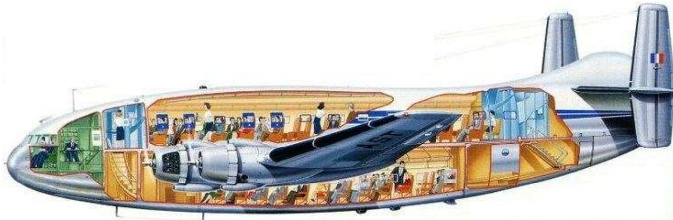
Le Breguet 765 "Sahara" (Deux-ponts) est une version militaire livrée à l'Armée de l'air française et utilisant des moteurs Pratt & Whitney R-2800-CB 16 de 2 500 ch. Il a été construit à 4 exemplaires.
