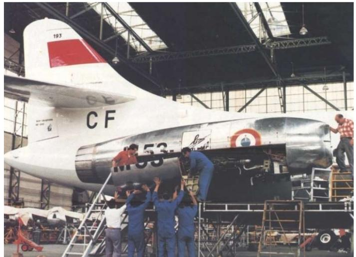
Installation du turbofan M53-2. La nacelle droite avait un diamètre de 1 m 66.
