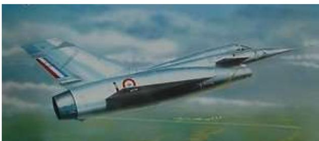
Majestueux malgré son fuselage "bedonnant" avec son immense tuyère (diamètre supérieur à 1 m 50), le Griffon II était un avion expérimental à aile delta très pure et plans canard combinant un Atar 101 E et un statoréacteur. Piloté par le célèbre pilote d'essais André Turcat, il est détenteur du record international de montée à 16 400 mètres à Mach 2,19, en février 1959,
