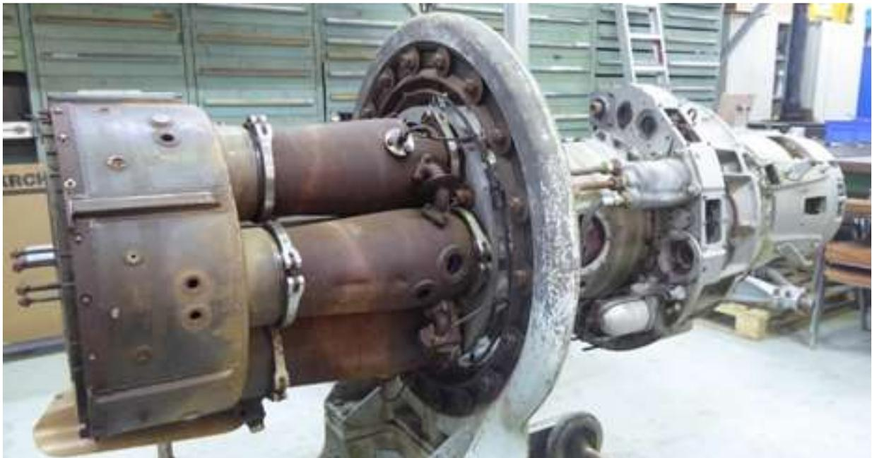
Vue arrière du carter externe de turbine et de la chambre de combustion à 6 tubes à flamme - 27/02/2019
