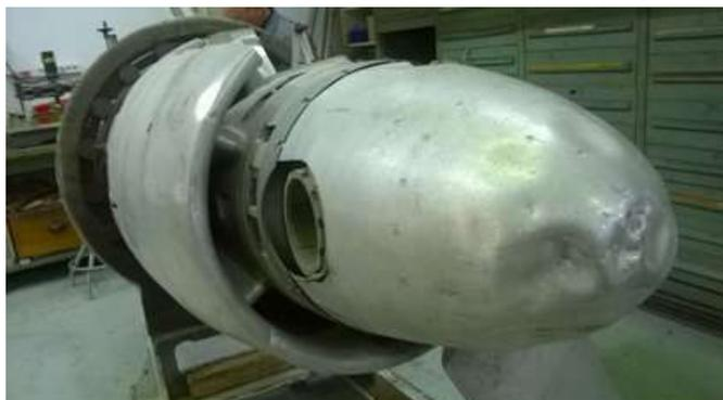
Cône-avant monté sur le porte-hélice et capot d'entrée d'air
