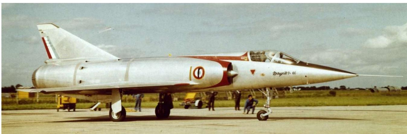
Mirage III T 01 propulsé par un TF-106 au roulage à Melun-Villaroche. La chambre réacteur est ventilée par des écopes.
