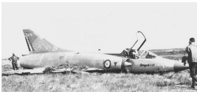
Alors qu'il vole à 20 000 pieds, il positionne accidentellement la manette des gaz sur ralenti. Il réduit sa vitesse mais le réacteur ne reprend pas. Hésitant à s'éjecter, il décide de tenter l'atterrissage sans moteur. Il termine sur le ventre près de la barrière d'entrée de piste avec le rideau de siège éjectable pendant le long du fuselage à cause des cahots du crash. Quant à l'avion, sa pointe avant est détruite, le fuselage plissé et les deux ailes sérieusement touchées.
