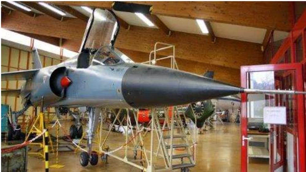
Mirage F-1 E01 / M53 à Latresne (Copyright Aérocampus d'Aquitaine). Près du train principal gauche se trouve l'éolienne de secours. Grâce au vent relatif du déplacement de l'avion, cette éolienne fournit une énergie minimale permettant d'alimenter les équipements essentiels de l'appareil (les commandes de vol entre autres) et ce, pour une durée illimitée.
