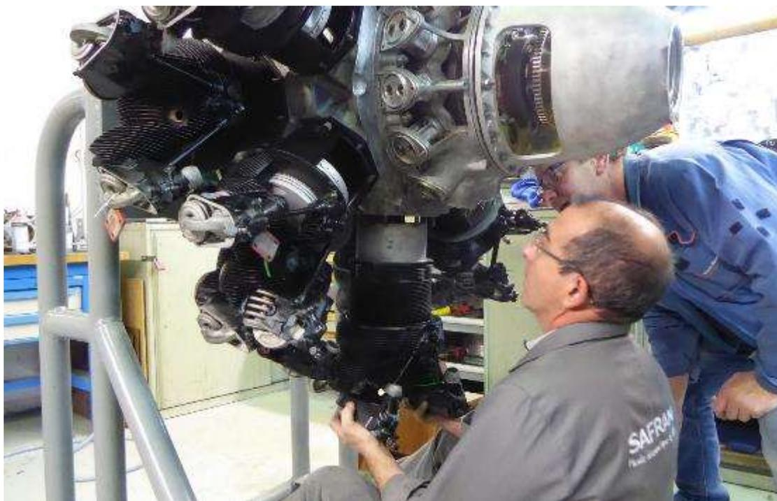
Il reste encore de nombreux accessoires à monter pour finir d'équiper ce 14 N-49 et notamment le moyeu d'hélice visible sur la photo ci-dessous. Ce moteur a été livré le 19 novembre 2019, l'armée de l'air ayant assuré la livraison.
