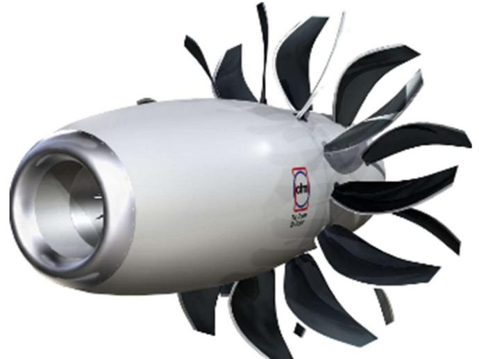
GE-36 - Open rotor à hélices coaxiales
