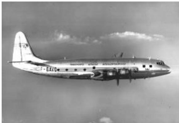
Au cours de la phase d'étude de cet avion, il est envisagé de ne pas utiliser les moteurs principaux pour faire l'électricité à bord. Il faut donc une source indépendante. Une turbine entraînant un alternateur paraît alors une solution crédible, en particulier en raison de sa légèreté.
