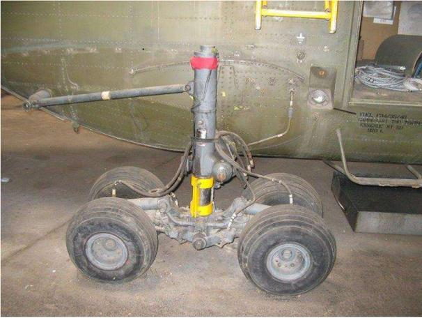
Train automoteur droit équipé de pneus lisses
