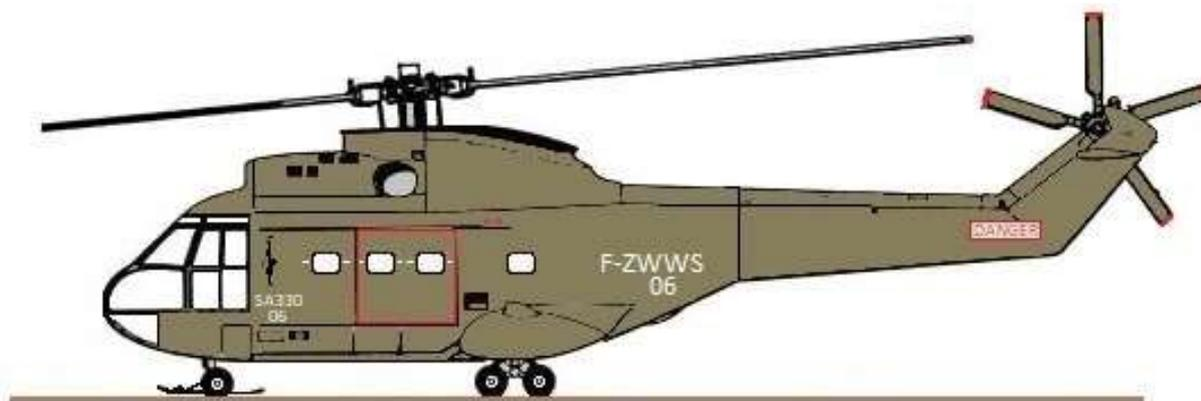
SA-330 "Puma" F-ZWWS n°06. Le train se compose de deux atterrisseurs principaux interchangeables et d'un élément avant. En plus de ses fonctions habituelles : absorption d'énergie, suspensions, escamotage, chaque atterrisseur principal possède la particularité d'être muni d'un dispositif de propulsion pour permettre les évolutions au sol, rotor immobile et pales repliées. L'entraînement est assuré par un moteur hydraulique alimenté par la génération de bord.
