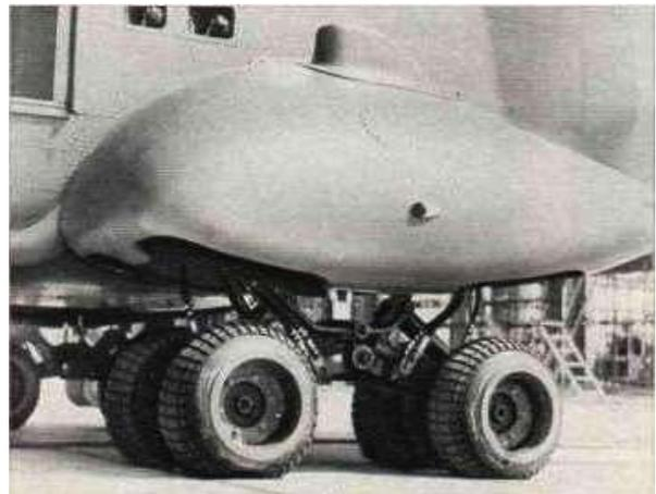
Train principal automoteur à deux bogies avec pneumatiques lenticulaires crénelés (1968)
