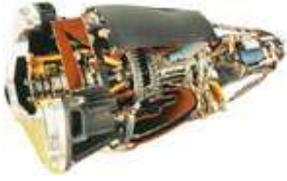
Au début des années cinquante, les premiers Snecma Atar fabriqués en série, les modèles 101 C et D, étaient équipés de démarreurs électriques anglais Rotax incorporés au turboréacteur et placés dans le moyeu à l'avant du compresseur. Alimenté par un courant d'environ 1000 ampères sous 28,5 volts, le dispositif fournissait une puissance de 13 ch et lançait le réacteur en 32 secondes.
