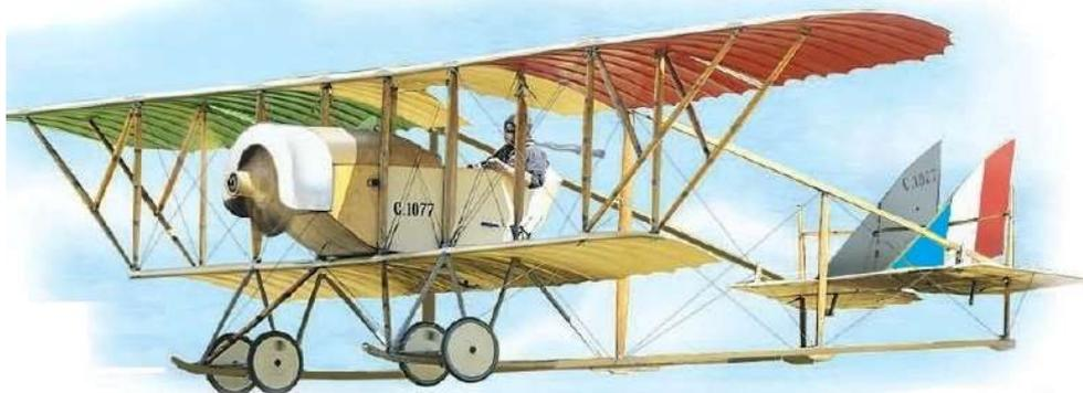
Surnommé " la cage à poule " en raison de sa structure très arachnéenne, et ressemblant à un ensemble de tubes, de voiles, et de cordes à piano le Caudron G.3 était propulsé par un moteur rotatif Le Rhône 9C de 80 ch (DR)
