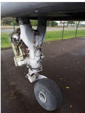
Atterrisseur auxiliaire (DR). De type à roue tirée, il est doté d'un système d'orientation facilitant les manœuvres au sol.
