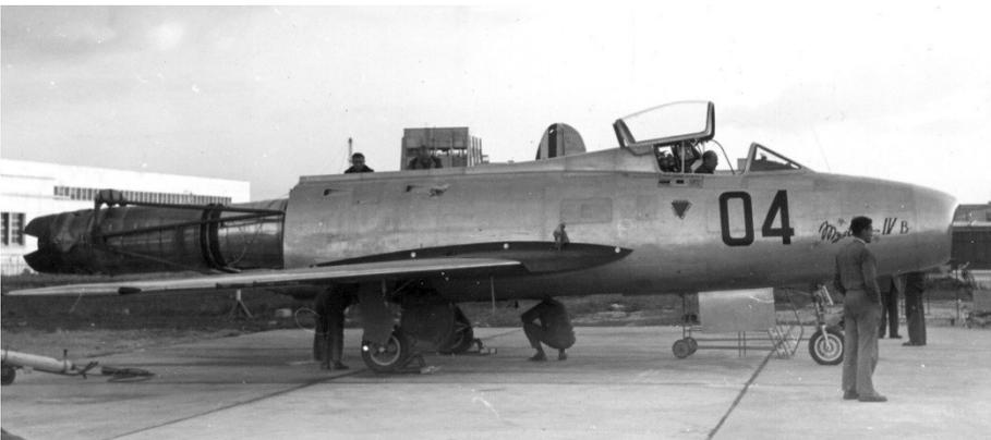
Avionnage d'un Atar 101 F sur le Mystère IV B-04. L'opération nécessite la dépose de l'empennage horizontal et vertical.
