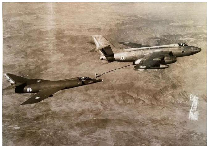
Essais de ravitaillement en vol entre l'Etendard IV M05 et le SO 4050 Vautour II A 8 (1960)
