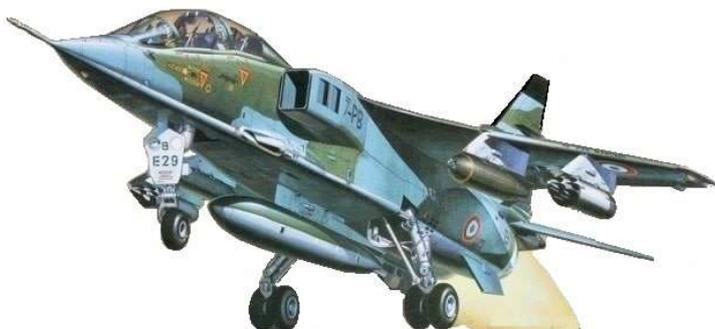
Pour ces avions à aile mince, le train d'atterrissage principal dit de fuselage se caractérise par une cinématique simple laissant à l'avion toutes ses possibilités pour l'emport de charges volumineuses sous le fuselage et par une construction en acier à très haute résistance.
