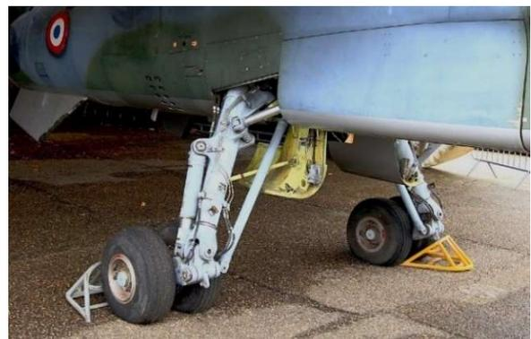
Atterrisseur principal (DR). Les roues pivotent au relevage, ce qui permet, train rentré, de les loger à plat dans le fuselage.
