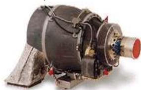
Issus de la lignée des Noëlle 60 et 80 étudiés et conçus pour les turboréacteurs Atar 8 et 9, les turbodémarrateurs Noëlle 150 ch et 180 ch, assurent respectivement le démarrage des moteurs M53-5 et M53-P2 en service sur les Mirage 2000.
