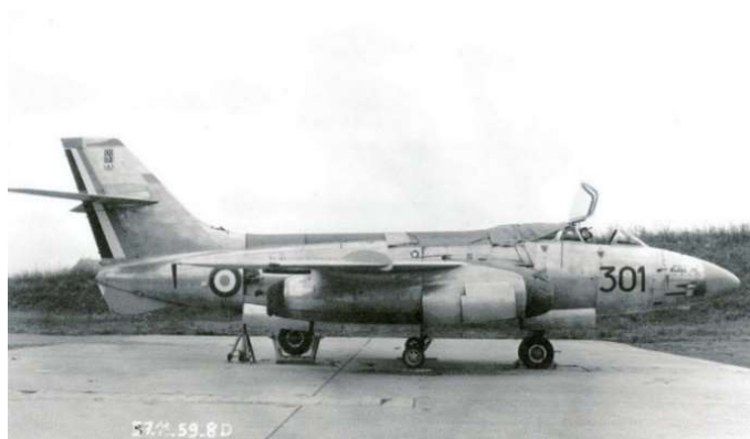
S.O. 4050 Vautour II N° 301 en place à la butte de tir pour réglage des canons (Novembre 1959)
