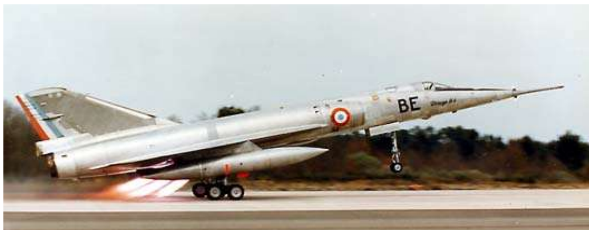
Mirage IV A au décollage (195 kt avec ses Jato. Aux 6,7 tonnes de poussée avec post combustion de chaque réacteur Atar 9 K13 s'ajoutaient ainsi 5,4 tonnes de poussée (@Dassault Aviation).
