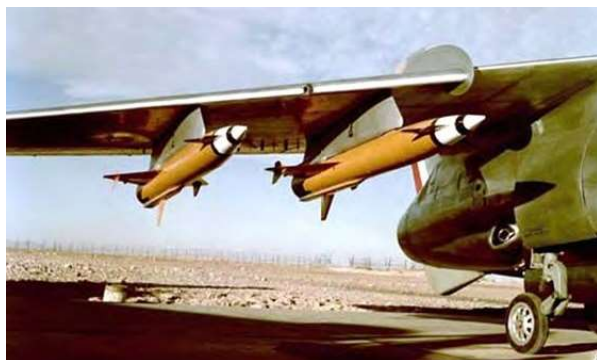
Missiles Matra R-511 (masse 180 kg). Premier missile français air-air opérationnel, le guidage se fait selon le mode de poursuite dit "à courbe du chien" (inspiré du célèbre principe de navigation) qui fait suivre au missile la ligne d'évolution de sa cible avec une trajectoire le plus souvent hasardeuse.
