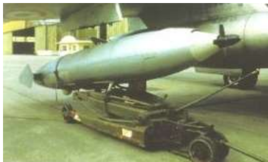
Pod " Chipiron ". De type quadripale, l'hélice entraîne un alternateur alimentant électriquement le pod.
