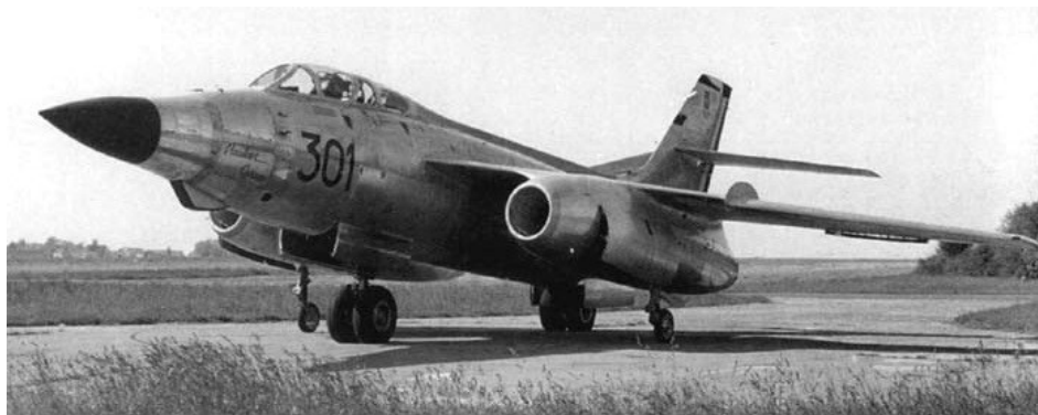
Le S.O. 4050 Vautour II N° 301 avec radome Cyrano II (1960). Le nom de Cyrano est dû à la pointe allongée du Mirage III dont la forme n'est pas sans rappeler l'appendice nasal du héros bien connu d'Edmond Rostand.
