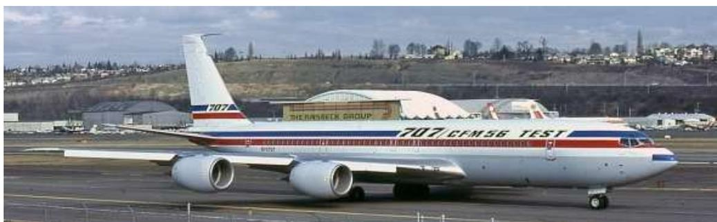
Boeing 707-700 c/n 21956 (N707QT) banc de test volant du CFM56-2. La garde au sol avec les CFM56, placés plus en avant et plus haut sur l'aile permet le décollage et l'atterrissage en toute sécurité. (@ Boeing)
