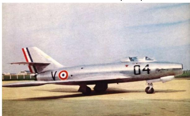
MD-452 Mystère II-04 avec réservoirs fuselés d'extrémités de voilure de 150 litres pour accroître l'autonomie
