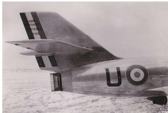
MD-452 Mystère II-015 (© AEVS). Les tiges parallèles à l'axe de l'avion, visibles à la sortie de la tuyère, servaient à empiler un nombre variable d'éléments de grille. (© AEVS)
