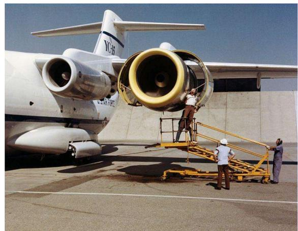
Moteur CFM-56 monté au point 1 de voilure
