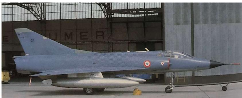
Mirage III C n° 21 au CEV avec deux réservoirs pendulaires de 1 300 litres (1986)
