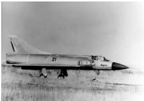
Mirage III C n° 21 Sortie d'usine de Bordeaux-Mérignac avec une fausse pointe radar (Juillet 1961)
