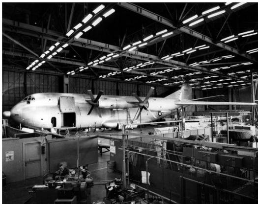
Douglas tanker. Vue générale de la maquette à échelle 1 du projet de Douglas XKC-132, dérivant d'une étude pour un avion de transport désigné XC-132 proposé à l'*USAF* dans le cadre de la compétition destinée au remplacement des ravitailleurs en vol *Boeing KC-97*. Propulsé par 4 turbo propulseurs *Pratt & Whitney T-57* de 15 000 chevaux, il aurait été capable de transporter jusqu'à 800 soldats. Le projet ne fut pas retenu. L'avion et son moteur ne connurent pas de développement ultérieur.
