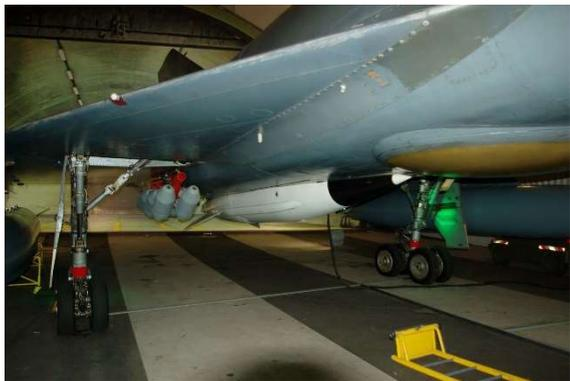
Mirage IVA en configuration typique d'une alerte nucléaire sur une base des FAS en France. L'arme à fission AN21 est en place dans la cavité inter réacteur, les fusées d'assistance au décollage (JATO) sont en position sous chaque voilure.
