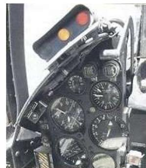
**Adhémar.** Le Mirage III C est équipé d'une sonde d'incidence à fentes dont les informations sont affichées sous forme de signaux lumineux en dessous de 250 nœuds (463 km/h). L'Adhémar comprend trois lampes, verte, ambrée et rouge, montées dans un boîtier au-dessus et à gauche du tableau de bord, qui s'allument dans l'ordre vert/vert-ambre/ambre/ambre-rouge/rouge selon l'importance de l'angle d'incidence et la proximité du décrochage.
