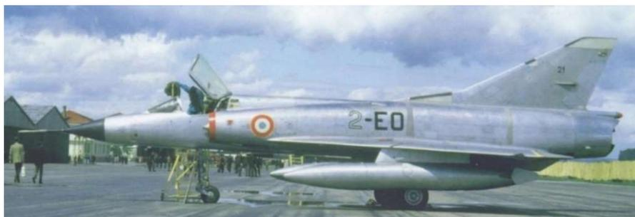
Le Mirage III C n° 21 codé 2-EO, sans insigne d'escadrille, équipé d'un nez Cyrano I bis et de réservoirs pendulaires de 1 300 litres (1967)
