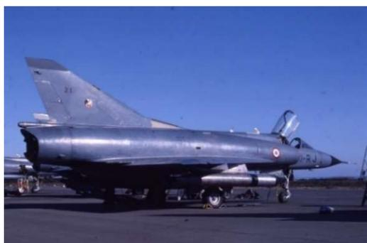
Mirage III C n° 21 10-RJ - EC 2/10 " Seine " avec combinés réservoirs-lance-roquette de 100 litres (JL-100R)
