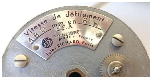
Vue du dessous du cylindre : gravure de la vitesse de défilement (180 mm en six heures), pignon moteur (à droite).
