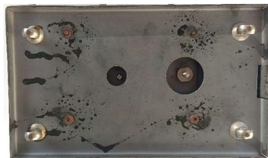
Vue du dessous du boîtier avec ses quatre crochets de fixation : orifice de passage de la clef à embout carré (à gauche) et axe de rotation du cylindre (à droite).
