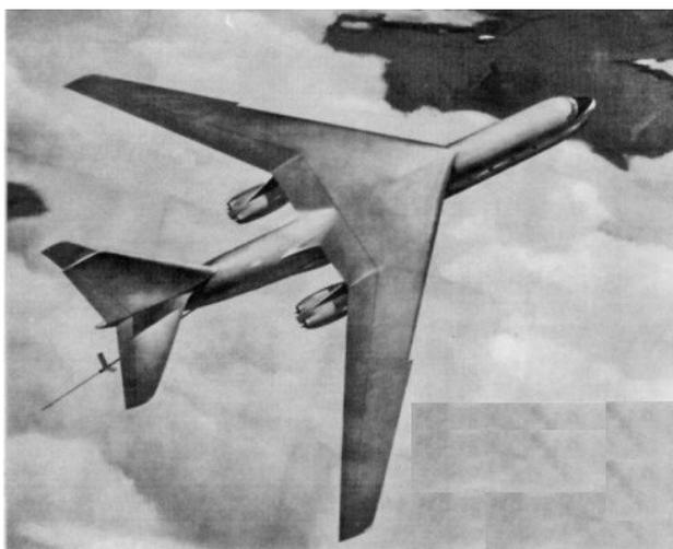
Vue d'artiste du projet tanker CL-321 de Lockheed. Deux options concurrentes existaient. L'une à aile haute, l'autre à aile basse et la position originale, en bord de fuite, des ailes des nacelles doubles pour les réacteurs JT-4 de Pratt & Whitney, les plus puissants disponibles aux USA à l'époque.
