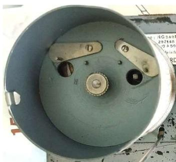
Vue intérieure du cylindre porte papier : réglages R - / A + (à gauche) et orifice de passage de la clef à embout carré (à droite). Le cylindre est amovible, en desserrant le bouton moleté axial.
