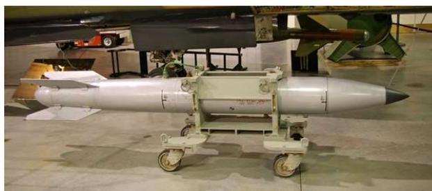
B-61 (Diamètre 34 centimètres, longueur 3,6 mètres, poids environ 325 Kilogrammes) Sa puissance est modulable de 0,3 KT (tactique) à plus de 100 KT (stratégique) voire jusqu'à 340 KT. La version B-61-12 est toujours en service dans les forces armées de l'OTAN.
