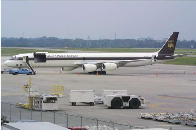
Douglas DC-8-71 Intégrateur UPS porte cargo latérale ouverte Les DC-8-71F et 73F étaient capables d'emporter jusqu'à 18 palettes du format standard. Ce DC-8 est sorti de la chaîne de production en 1968. Il a été retiré du service le 30 mars 2010.
