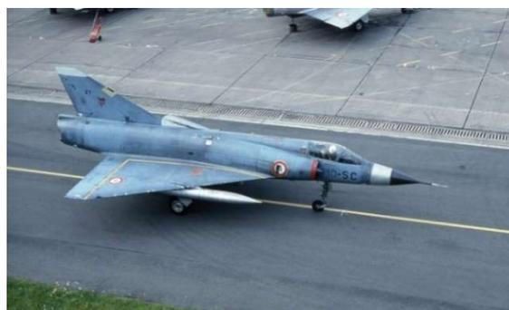
Mirage III C n° 21 10-SC - EC 1/10 " Valois " avec 2 réservoirs de 500 litres plaqués sous les ailes et dits " supersoniques "
