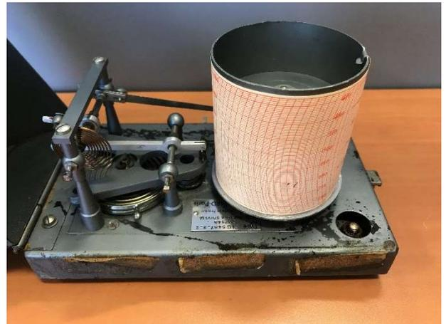
Baromètre-enregistreur NG 5489-2-2. Le doigt métallique situé au centre de l'embase du boîtier permet de maintenir le stylet encreur en position écartée, pour éviter d'écrire sur le papier.
