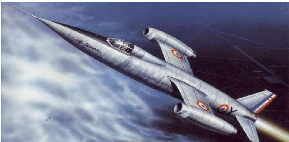
SO 9000-01 Trident I avec réacteurs MD-30 ASV 5 " Viper " à flux axial de 745 kgp (@ Heller)
