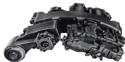
Les accessoires sont montés sur le carter d'entrée de la chambre de combustion : à gauche, le groupe des pompes carburant, puis le régulateur ; derrière, les pompes à huile
