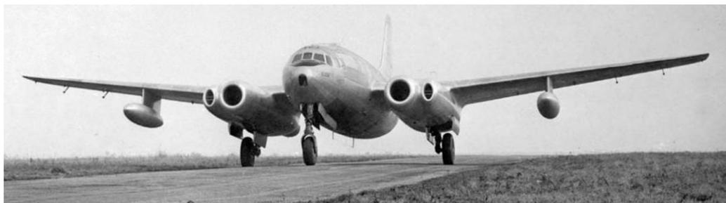
SNCASO SO-30 " Atar " (Janvier 1953). A l'instar du SO-30 " Nene ", il possède un empennage monodérive, des ailes aux extrémités tronquées et deux ballonnets de carburant d'une capacité unitaire de 825 litres.
