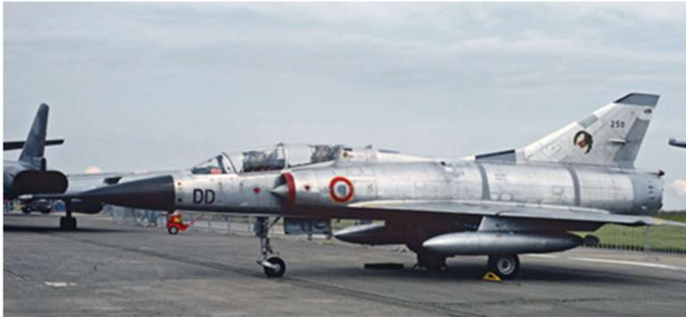
Mirage III B-RV n° 250 du CIFAS 328. Il fait partie des dix exemplaires construits sous le vocable de Mirage III B2 avec une pointe avant renforcée pour recevoir une perche sèche de ravitaillement en vol Mirage IV A et un phare. Ils sont restés en service entre 1967 et 1992.
