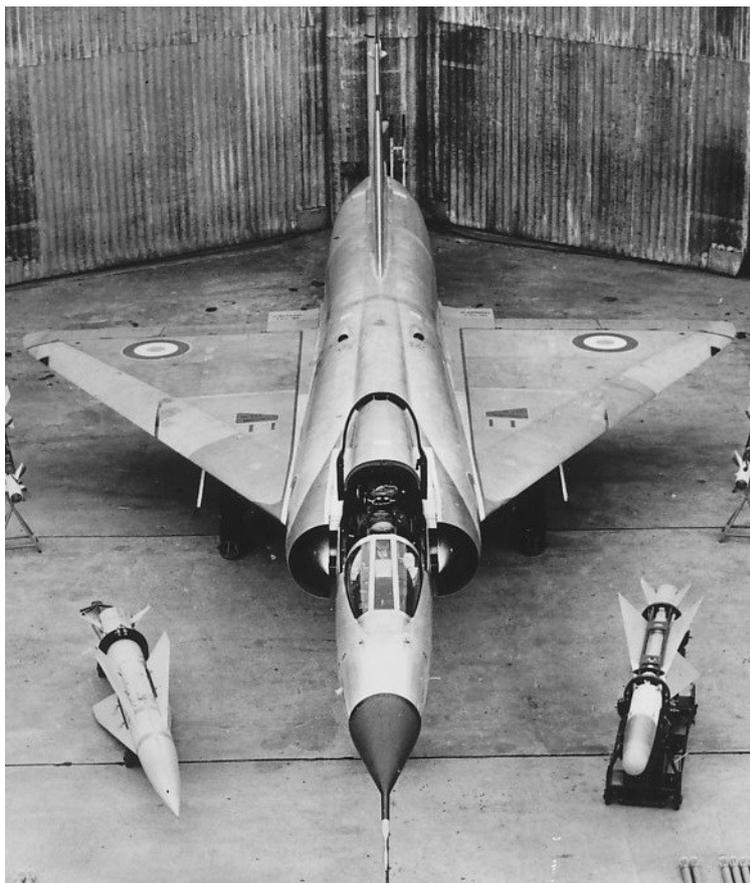
Mirage III E avec un missile air-sol AS37 Martel et un missile air-air R530 (Coll. MJC via 4<sup>ème</sup> EC)
